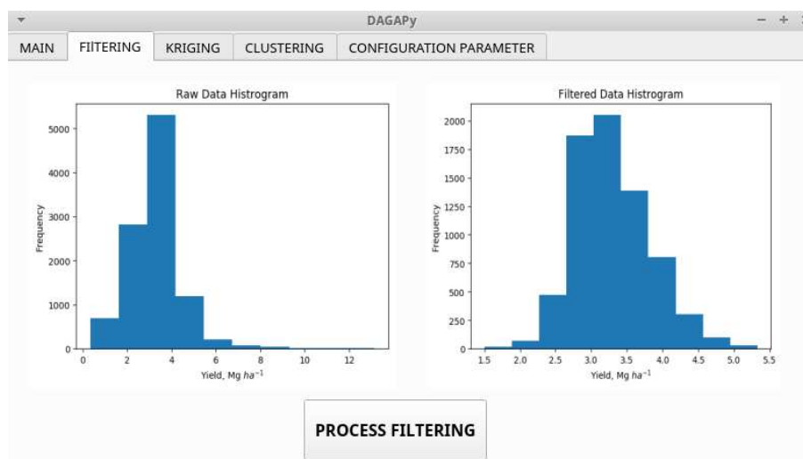
Figura 2.3 - Janela do programa de computador para execução da filtragem, mostrando o histograma dos dados brutos e filtrados. Fonte: Coelho et al. (2018)
