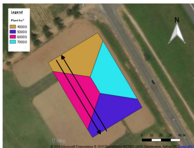
Figura 3.6. Mapa de semeadura com as quatro zonas de manejo, utilizado no ensaio em campo. As setas indicam a direção de deslocamento da semeadora sobre o talhão. Fonte: Coelho et al. (2020).
