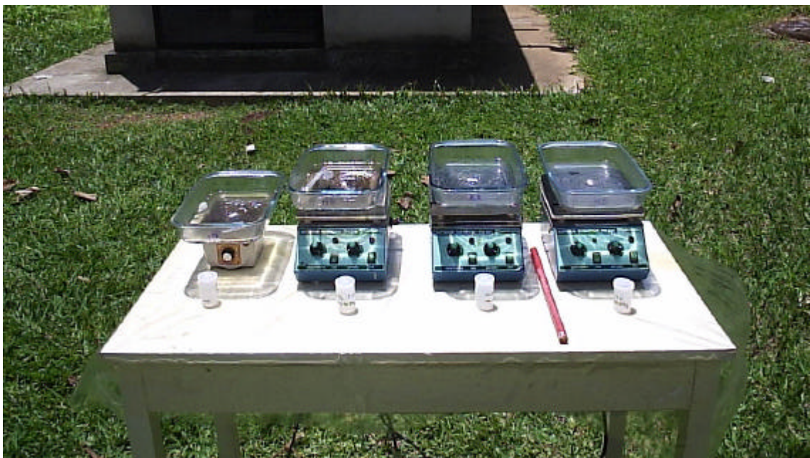
Figura 4 – Fotografias dos fotorreatores químicos.
