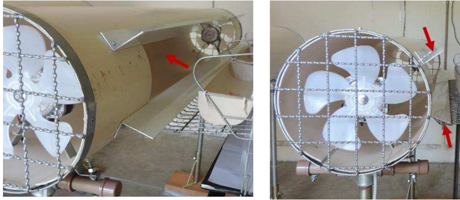
Figura 8. Abertura implementada no tubo PVC e aletas de alumínio para o direcionamento do fluxo de ar na altura das aves. As setas vermelhas indicam a saída de ar direcionada.
