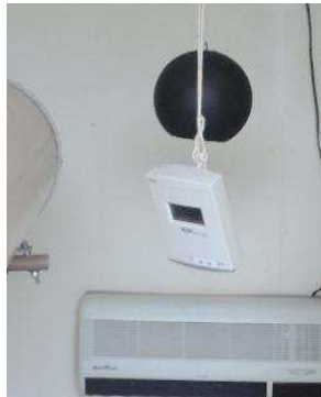
Figura 4. Vista do sistema independente de aquisição de dados data logger HOBO® LCD e globo negro instalados no interior das câmaras climáticas.
