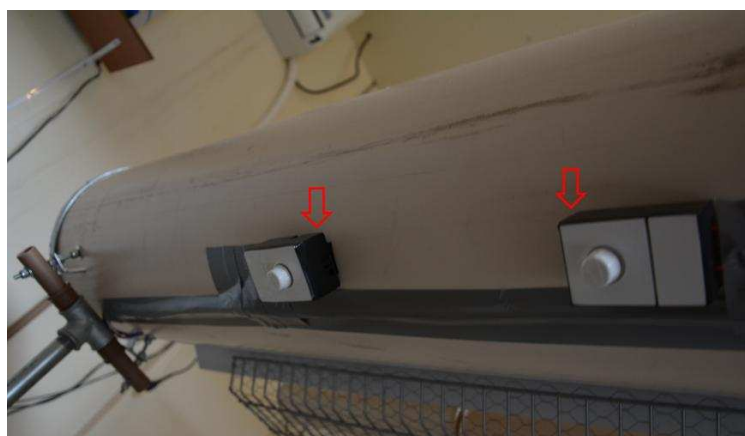
Figura 11. Dispositivos eletrônicos de controle individual da velocidade de rotação do micromotor elétrico (dimmer) dos ventiladores, utilizados para a regulação da velocidade do ar.
