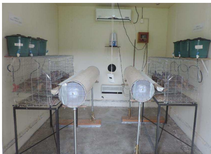
Figura 12. Disposição dos sistemas independentes de ventilação com controle da velocidade do ar no interior das câmaras climáticas.
