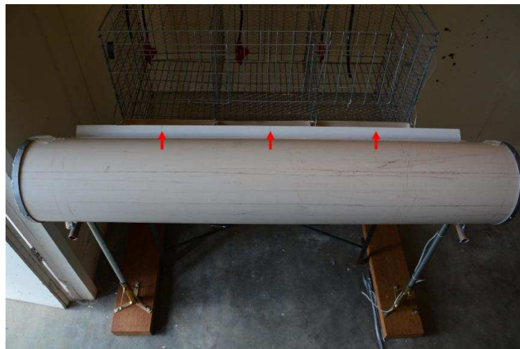
Figura 9. Vista superior dos pontos de ajuste da velocidade do ar, de acordo com os tratamentos. As setas indicam o local de calibração.
