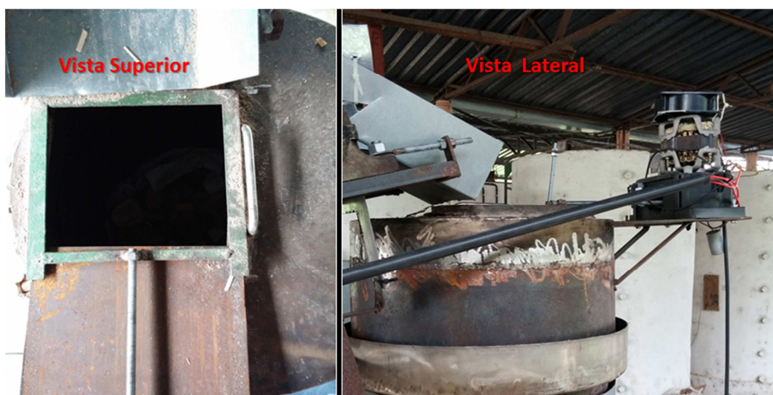
Figura 40 - Sistema de abertura e fechamento do reator.
