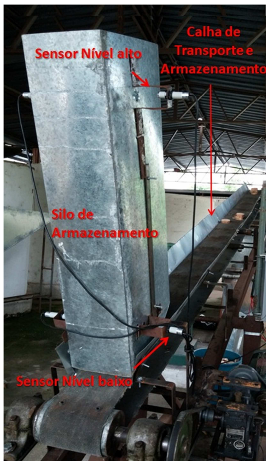
Figura 37 - Sistema de armazenamento e medição de nível.
