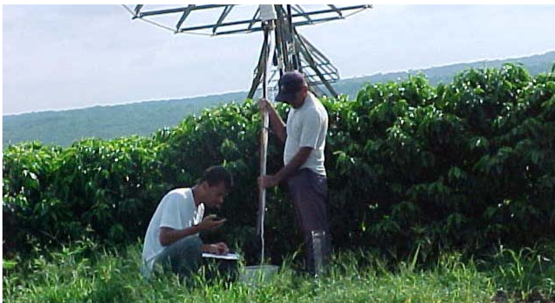
Figura 6 – Detalhe do uso do dispositivo para coleta do volume de água aplicado pelo emissor Lepa em campo.
