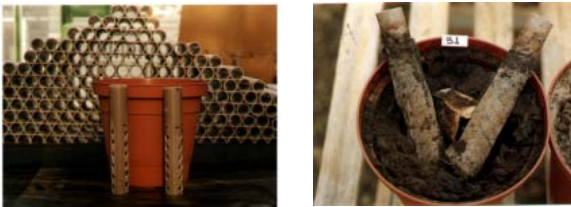
Figura 1. Detalhe dos tubos de PVC furados (A) e envoltos por uma tela de PVC e por um tecido de poliéster (B), visando minimizar a entrada de partículas minerais e orgânicas do solo das unidades experimentais.
