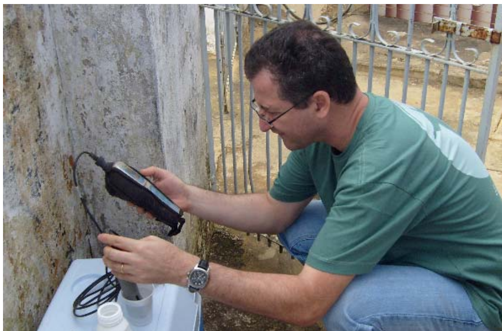
Figura 19 - Processo de medição de pH, temperatura e condutividade elétrica em campo.
