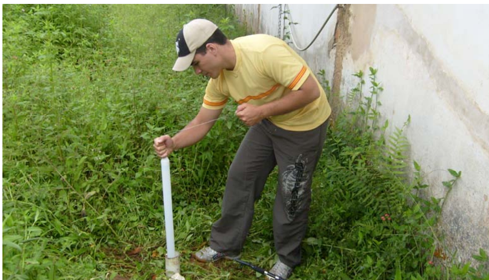
Figura 18 - Processo de coleta das amostras usando bailers.
