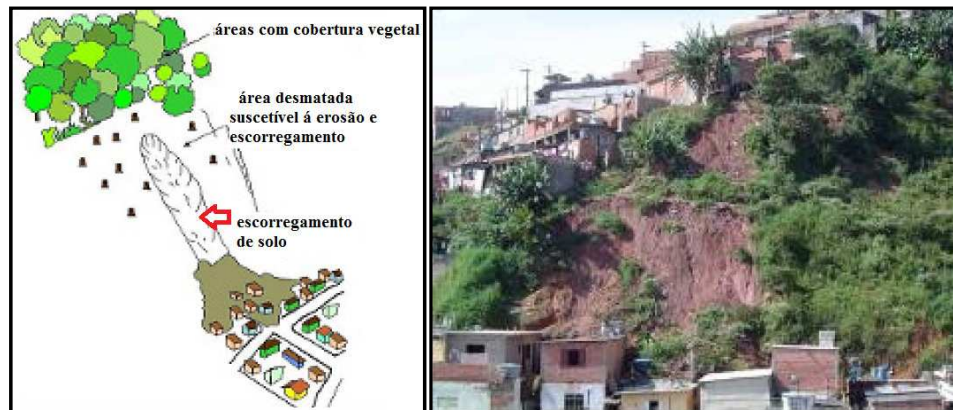
Figura 7: Esquema representando a remoção da cobertura vegetal. Fonte: (CAMPOS, 2011).
