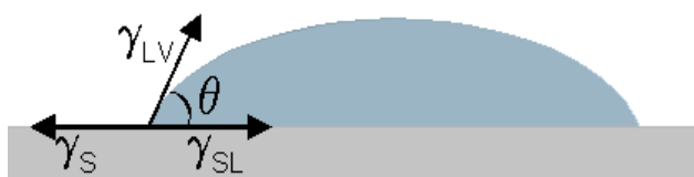
Figura 1- Ângulo de contato ( \theta ) entre uma gota líquida e uma superfície plana e horizontal. As tensões interfaciais da superfície do sólido ( \gamma_S ), do líquido em equilíbrio com o vapor ( \gamma_{LV} ) e superfície/líquido ( \gamma_{sl} ).
