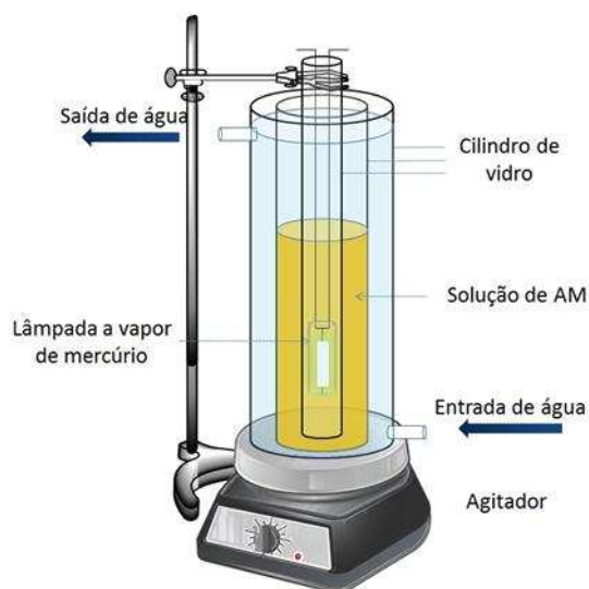
Figura 4. Esquema do fotoreator empregado nos testes fotocatalíticos.
