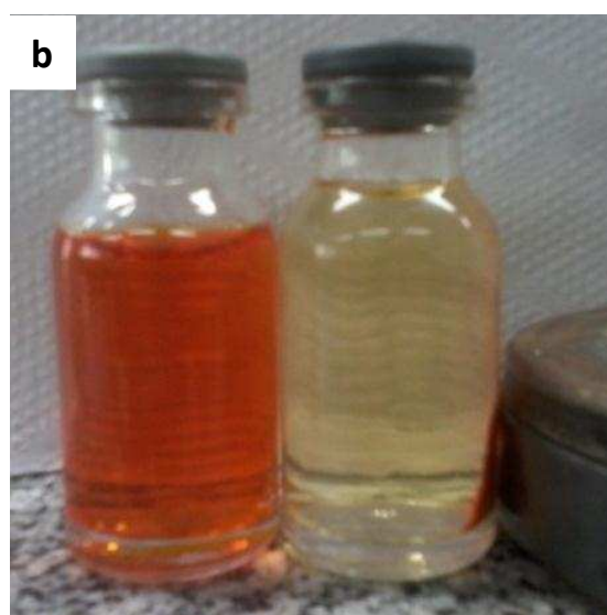
Figura 24. (a) Espectro de absorção UV-visível para a degradação do alaranjado de metila usando o catalisador MgZnAl-Fe e (b) Solução do alaranjado de metila, antes e após a fotodegradação.
