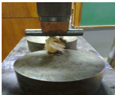
Figura 2 – Prensa manual de compressão simples para análise de resistência óssea
