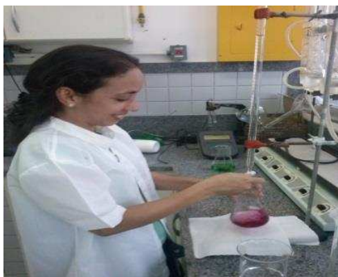
Figura 6 – Titulação para a Análise de Proteínas Colagenosas utilizando solução de HCl
