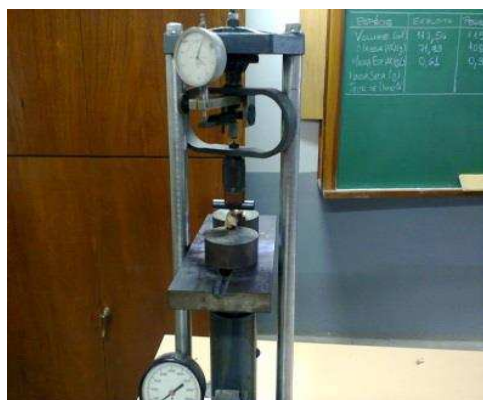
Figura 3 – Prensa manual de compressão simples para análise de resistência óssea
