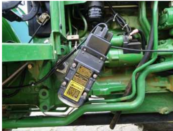
Figura 5 – Unidade de radar para medição da velocidade instantânea
