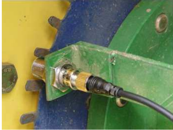
Figura 6 – Sensor indutivo PRCM18-8DP instalado no suporte
