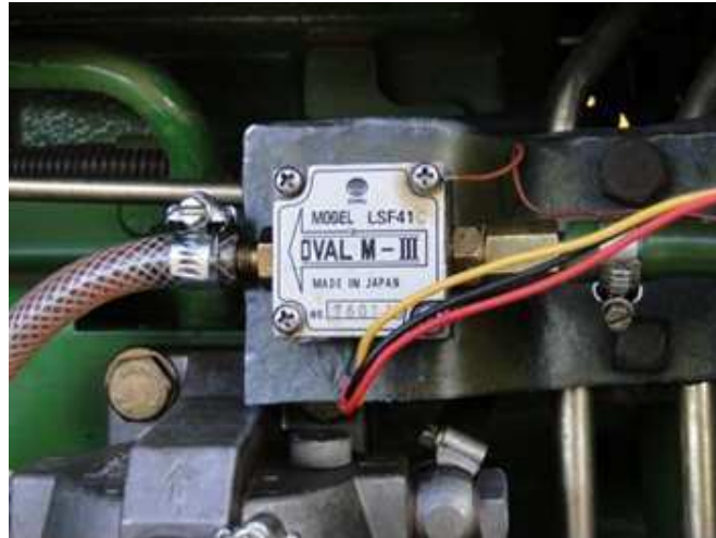
Figura 8 – Fluxômetro utilizado para determinação do consumo de combustível
