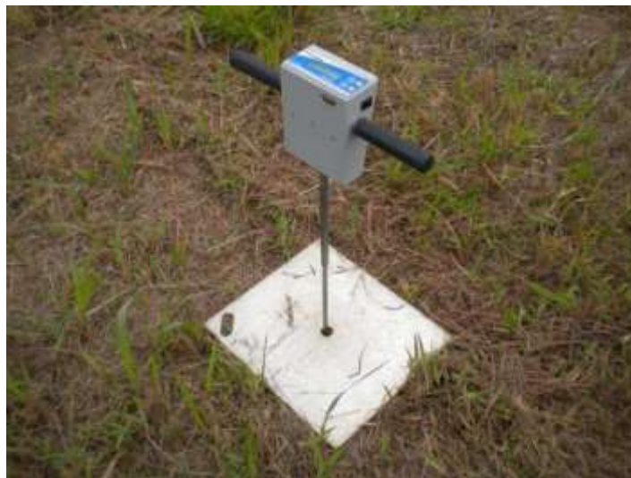
Figura 4 – Penetrômetro Falker penetroLOG utilizado no experimento
