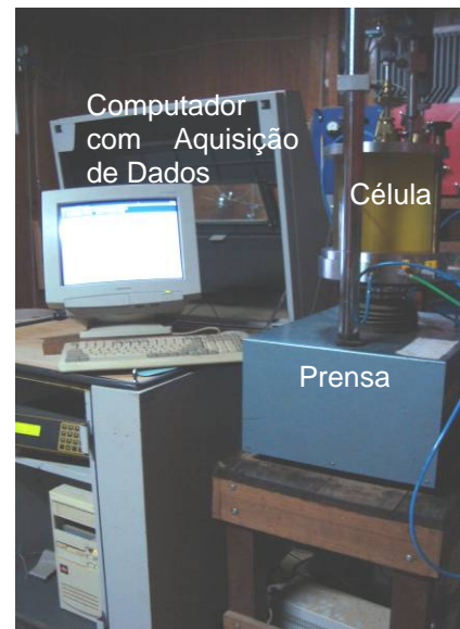
Figura 4.49 Equipamentos utilizados durante a execução do ensaio triaxial com sucção controlada.
