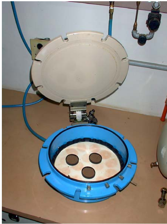
Figura 2.2 Câmara de Richard aberta com placa porosa e algumas amostras de solo (Custódio, 2003).
