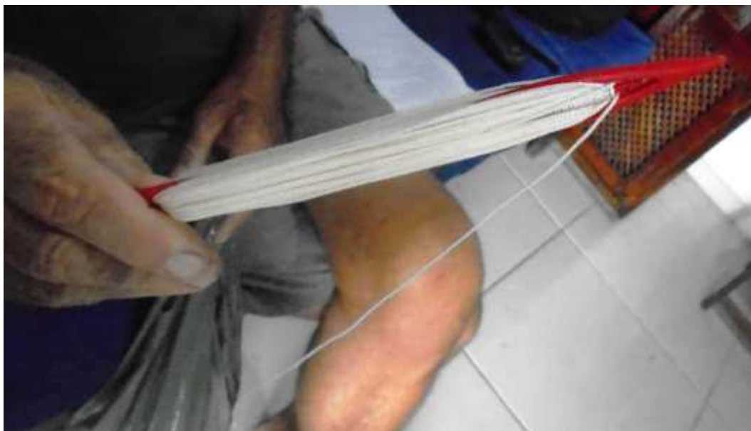
Figura 56. Agulha usada para emendar redes, Resex-Mar de Arraial do Cabo-RJ, 2016. Fonte: Dados da pesquisa 2016.
