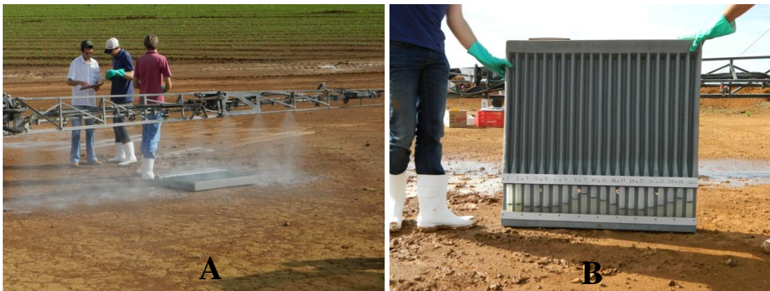
Figura 5 - Coleta de calda para determinação da uniformidade de distribuição volumétrica (A). Mesa posicionada na posição vertical para a coleta (B).
