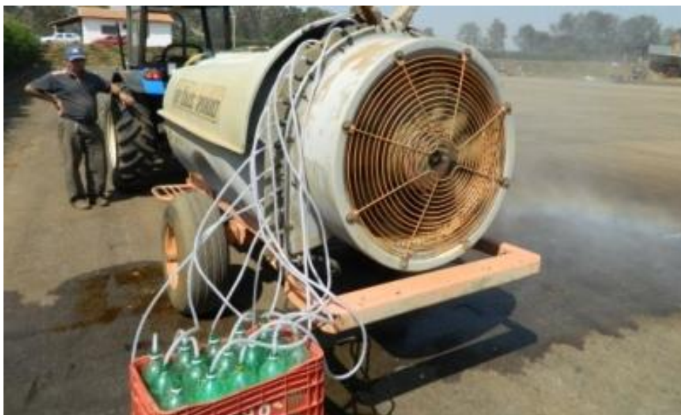
Figura 3 - Procedimentos e materiais utilizados para coleta da calda em pulverizador hidropneumático.
