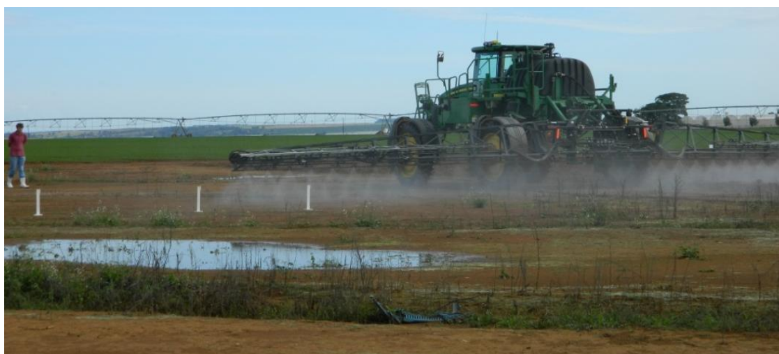
Figura 4 - Avaliação do percentual de deriva em pulverizador hidráulico.
