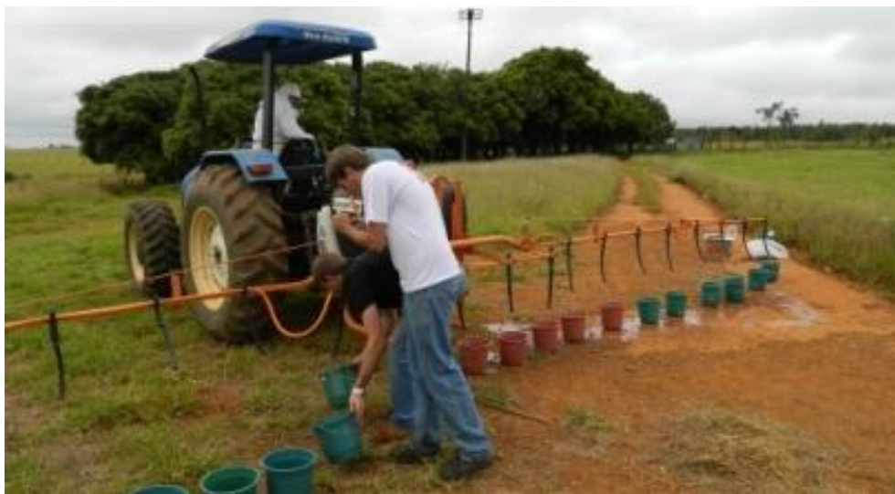
Figura 2 - Procedimentos e materiais utilizados na coleta de calda em pulverizadores hidráulicos.
