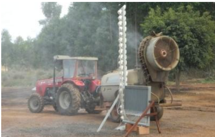
Figura 6 - Coleta de calda com mesa de avaliação de uniformidade de distribuição volumétrica vertical.
