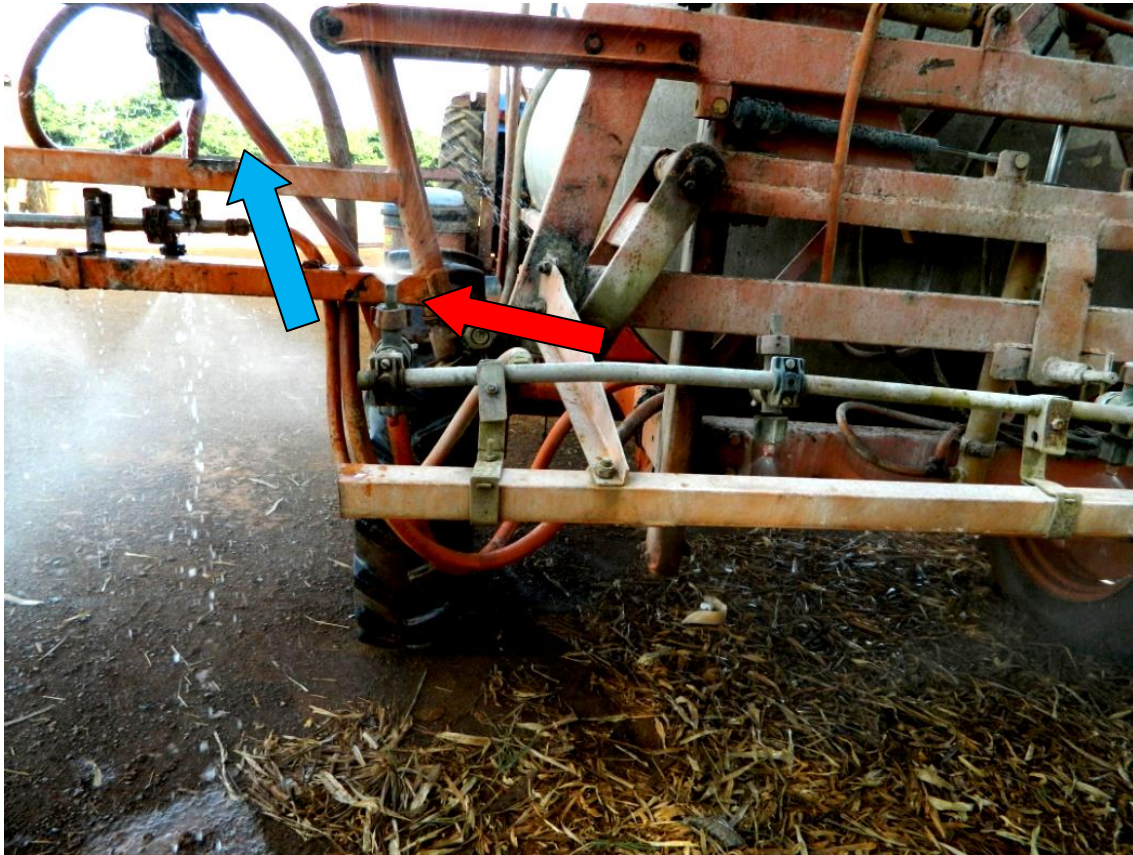
Figura 8 - Ponta posicionada de forma inadequada, com jato de pulverização voltado para cima (seta vermelha) e vazamento em filtro de linha (seta azul).
