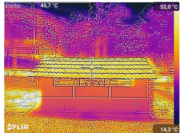
Figura 4 – Termografia infravermelha dos protótipos às 12:00 horas: a) telha cerâmica com painel fotovoltaico; b) telha cerâmica; c) telha de fibrocimento com painel fotovoltaico; d) telha de fibrocimento; e) telha metálica com painel fotovoltaico; f) telha metálica
