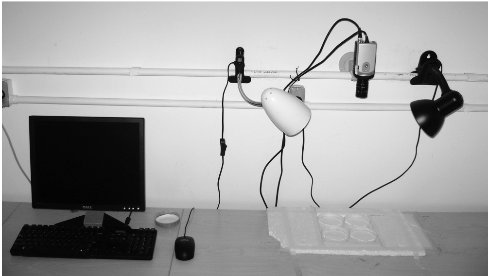
Figura 1. Sistema de rastreamento utilizado nos bioensaios comportamentais composto por uma câmera de vídeo acoplada a um computador. Sistema utilizado nos dois artigos da tese.
