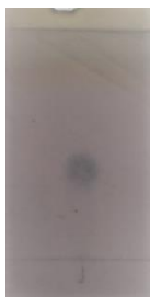
Figura A24. Cromatografia em camada delgada do aduto exo (1) eluida em hexano/acetato de etila 2:1 (v/v).
