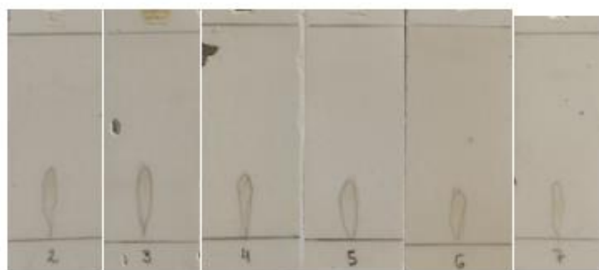
Figura A25. Cromatografias em camada delgada dos ácidos (2-7) eluidas em hexano/acetato de etila/metanol 1:1:0,5 (v/v/v)
