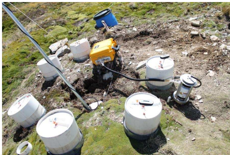
Figura 3: Sistema automatizado LI-8100 (LI-COR Biosciences, USA) (amarelo) acoplado ao colar de PVC no momento da medição.
