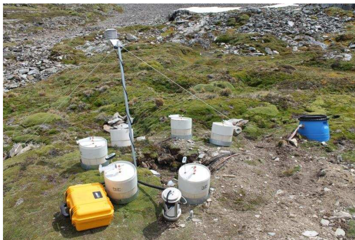
Figura 2: Esquema amostral utilizado no ambiente mais alto (TUA). Na bambona azul estão os dispositivos de armazenamento da temperatura e conteúdo de água no solo. O sensor de temperatura do ar está suspenso por haste metálica. No canto inferior a esquerda está o Licor, equipamento utilizado para coleta de emissões de \text{CO}_2 . As seis câmaras de PVC são para coleta de \text{NO}_2 e \text{CH}_4 .
