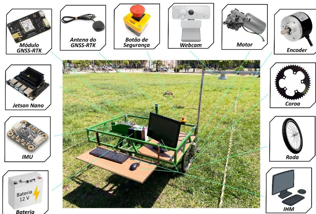
Figura 4 - Sistema mecânico, elétrico e eletrônico da plataforma robótica utilizada, Link: https://youtu.be/XvfqyicldCQ .
