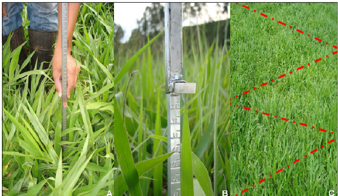
Figura 5 – (A) Uso do sward-stick para medição da altura; (B) Toque da base de acrílico em uma folha (C); e Percurso dentro do piquete para medição de altura do dossel forrageiro.
