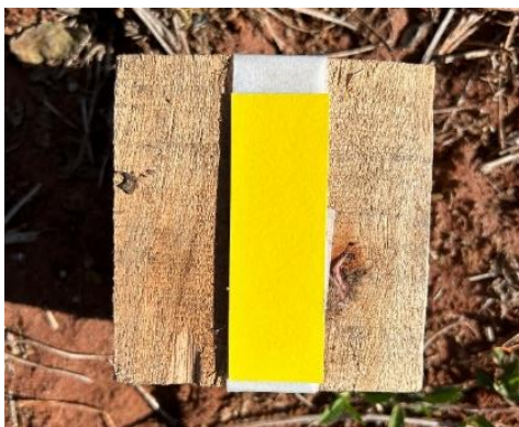
Figura 3: Papel hidrossensível a 7 cm da superfície do solo aderido ao bloco de madeira
