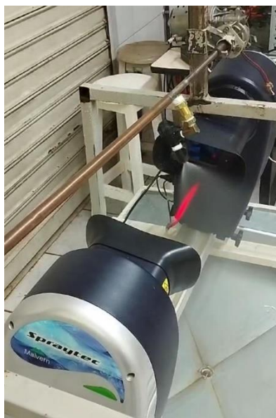
Figura 1: Analisador de partículas a laser Spraytech da Malvern Instruments Co.® (Marconi Ribeiro Furtado Junior)
