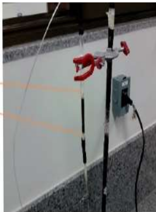
Figura 2. Sistema experimental de adsorção de As(V) em coluna de leito fixo preenchida com PMQ-EDA-Fe(III).
