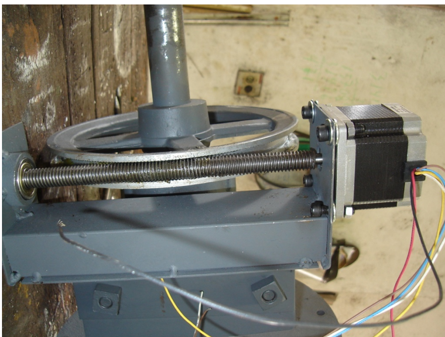
Figura 1.7: Cremalheira e motor de movimentação sobre eixo vertical.
