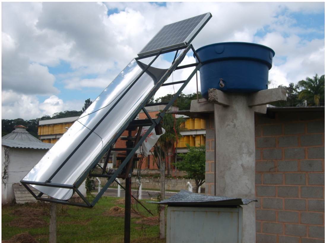
Figura 3.11: Sistema, calha cilindro-parabólica com painel fotovoltaico acoplados ao rastreador.
