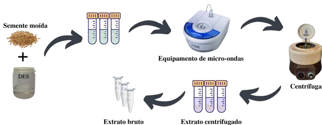
Figura 12 - Esquema do processo de extração assistida por micro-ondas, utilizando NADES
