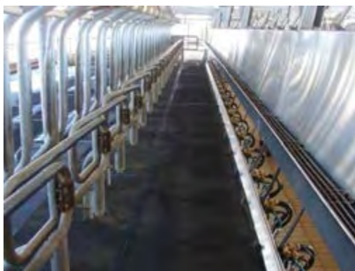
Figura 218 – Estrutura de contenção de animais na ordenha
