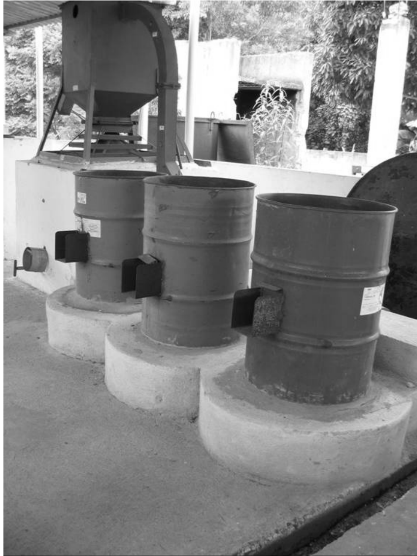
Figura 2 – Secador utilizado na secagem dos grãos de soja.
