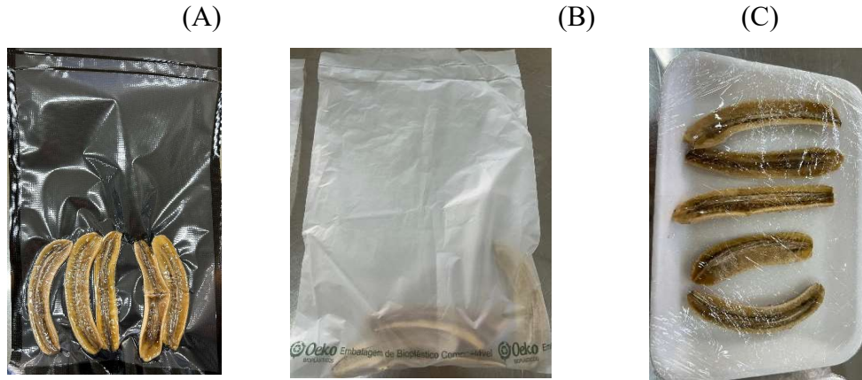
Figura 4. Embalagens utilizadas para o armazenamento das bananas: saco plástico de polietileno à vácuo (A), saco transparente de bioplástico compostável (B) e bandeja de isopor envolta com filme de PVC (C)
