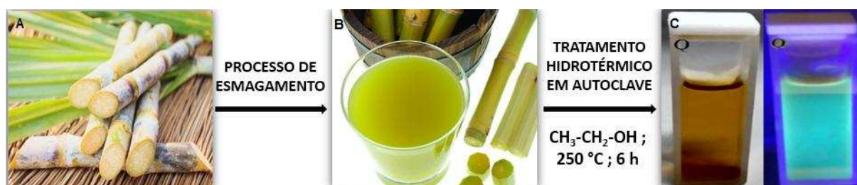
Figura 8: Esquema de síntese dos CDs empregando o processo hidrotérmico. (A) cana de açúcar, (B) caldo de cana após a moagem, (C) solução final de CDs.
