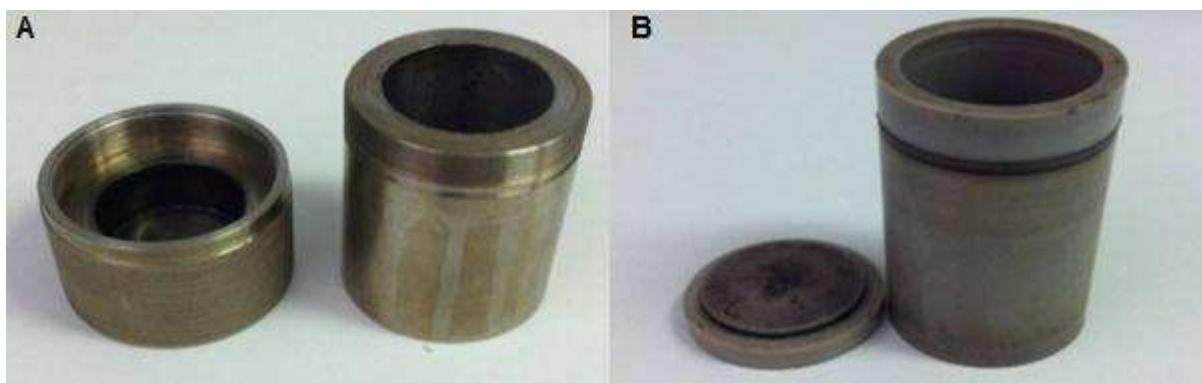
Figura 7: (A) autoclave de aço inoxidável, (B) recipiente de teflon.
