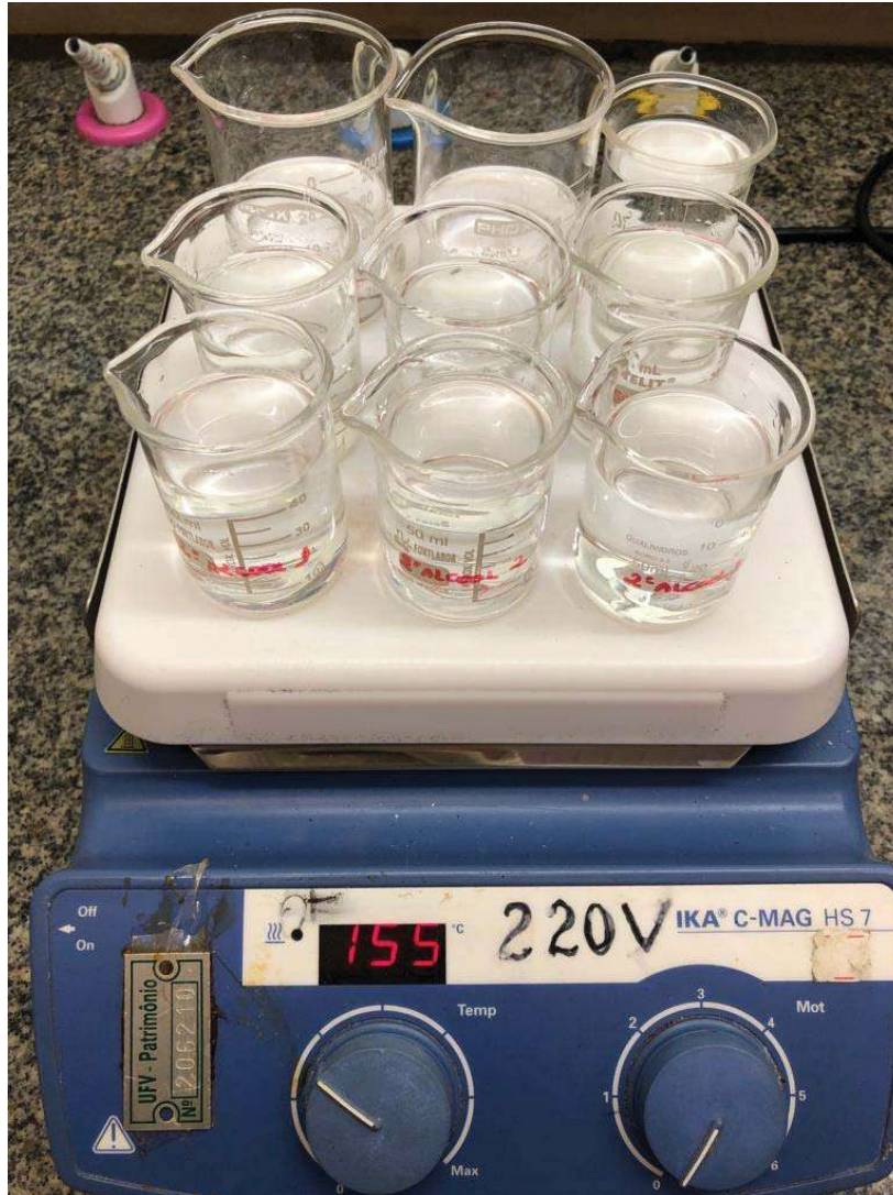
Figura 15- Banho evaporador para análise de resíduo das amostras
