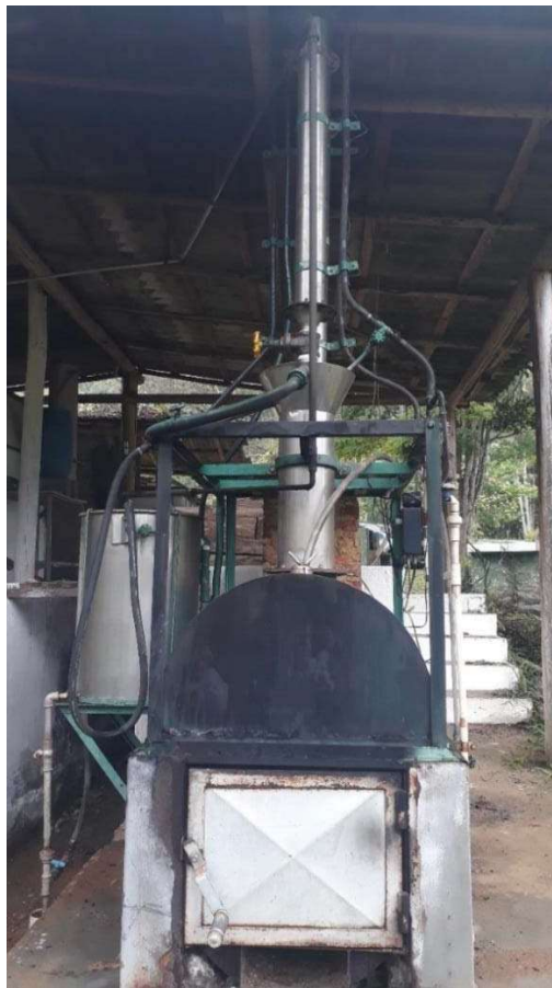
Figura 9- Alambique de inox 300L utilizado na destilação da cachaça
