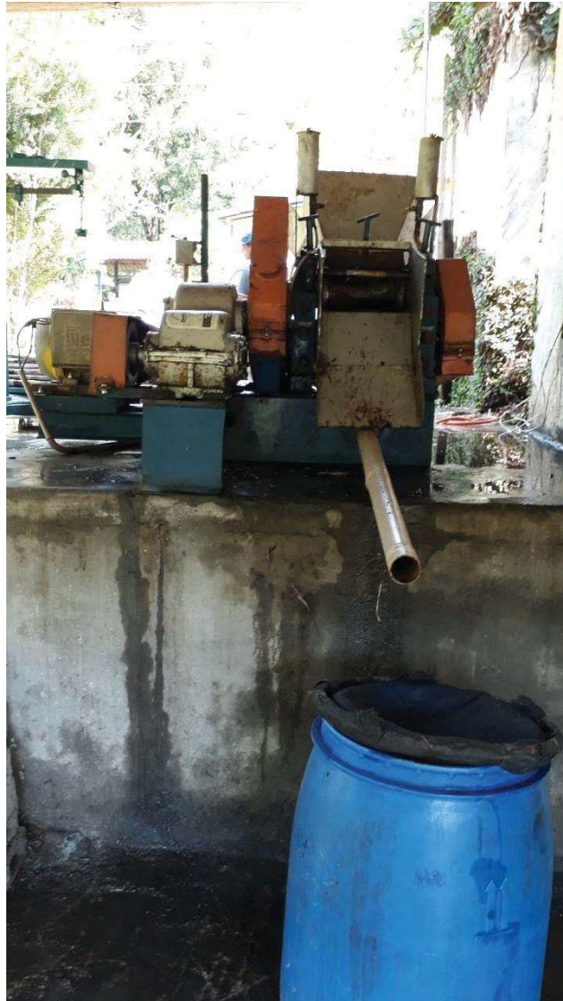
Figura 7- Moinho elétrico utilizado para extrair o caldo da cana de açúcar
