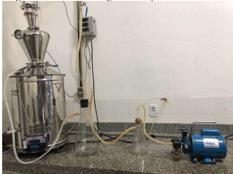
Figura 12- Sistema de esgotamento por bomba de vácuo
