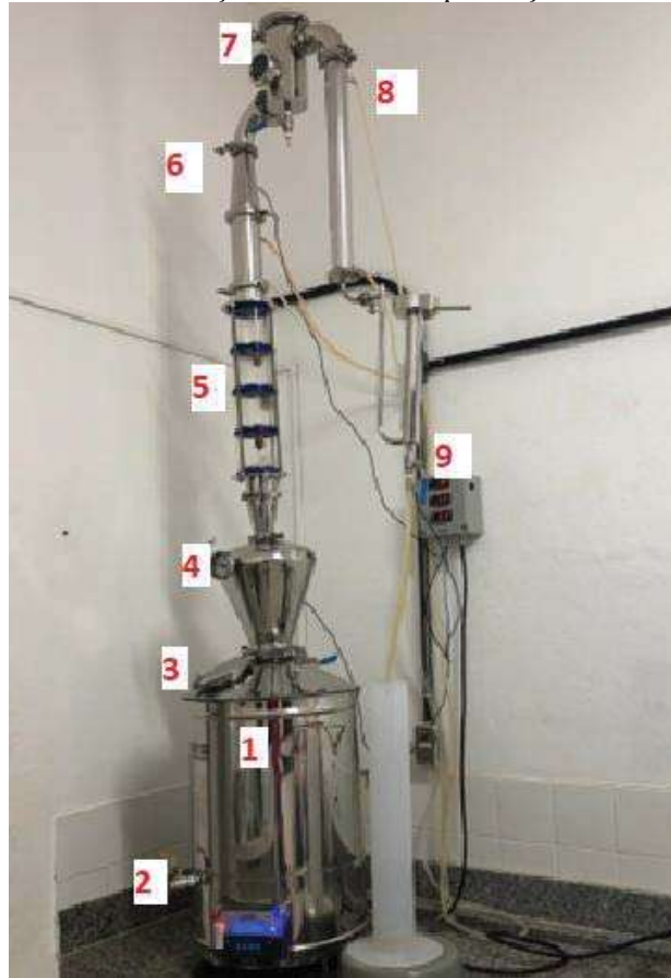
Figura 10- Coluna de retificação utilizada na produção do álcool combustível
