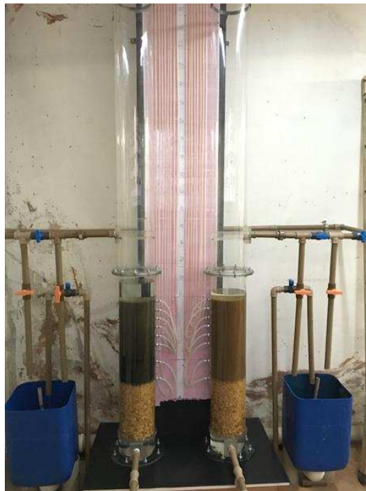
Figura 24. Vista geral das unidades piloto de filtração
