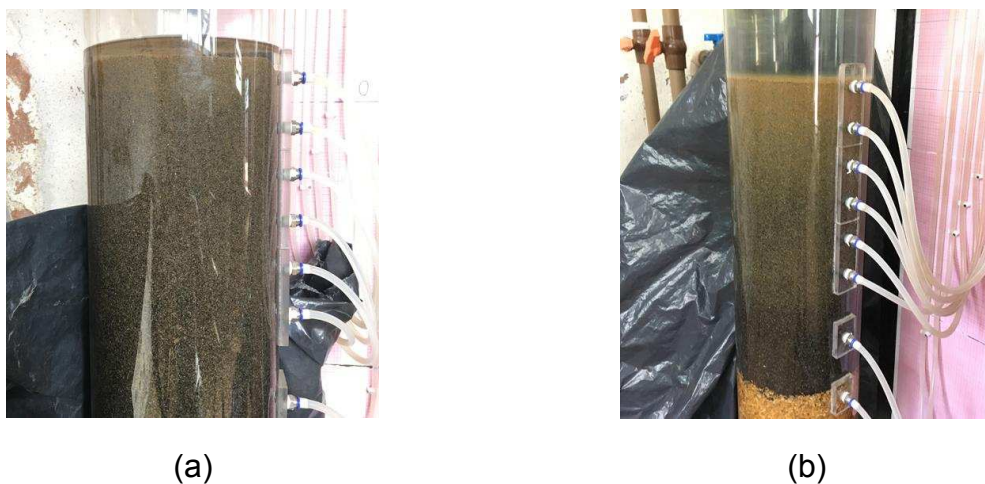
Figura 60. Aspecto do leito de areia de britagem após o encerramento da carreira - taxa de 360 \text{ m}^3 \text{ m}^{-2} \text{ d}^{-1} (a) Carreira 6 – período de estiagem (b) Carreira 13 – período chuvoso
