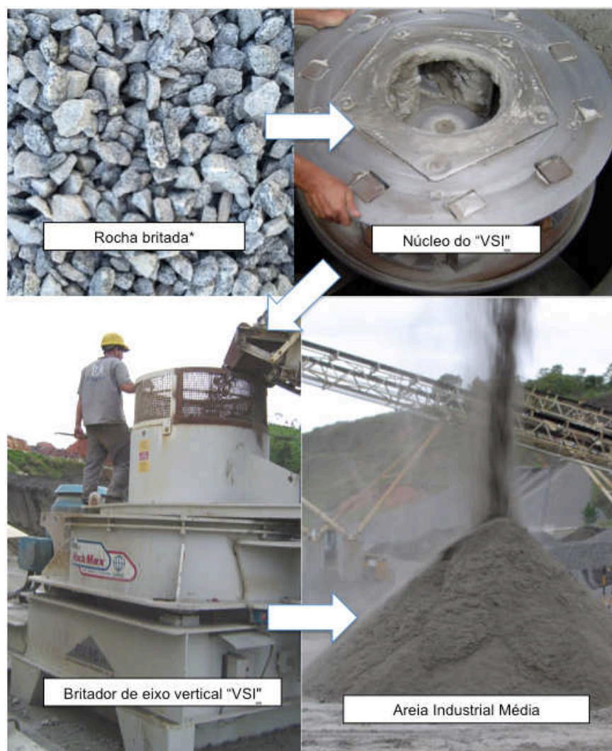
Figura 20. Produção da areia de britagem em britador vertical de impacto
