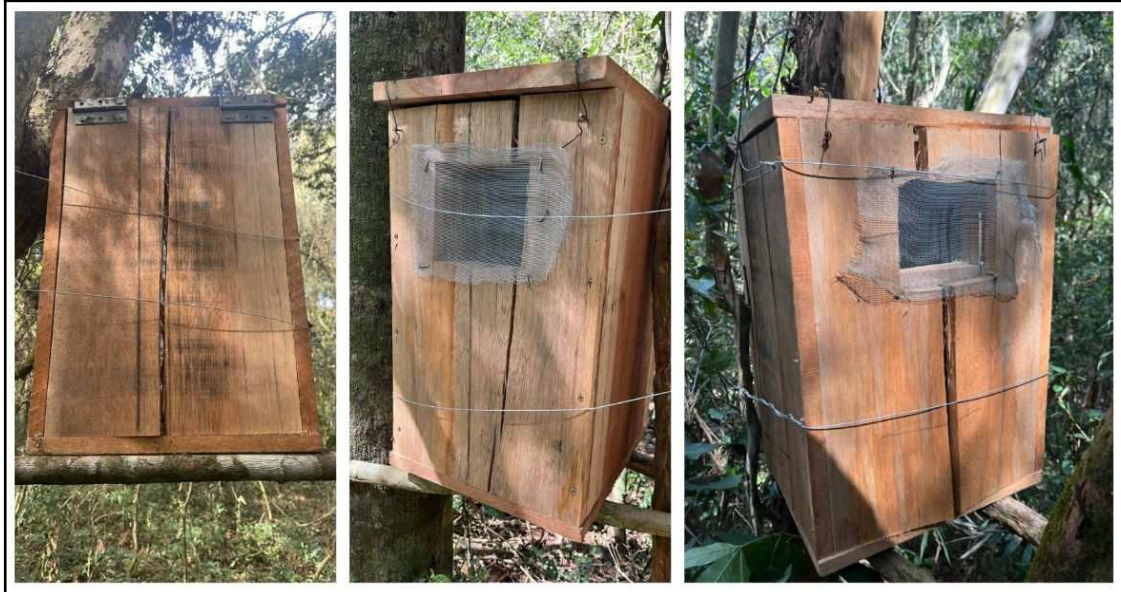
Figura 6. Exemplos das rachaduras que surgiram nos dormitórios artificiais (DA) dos modelos DA Ar e DA Rocha.
