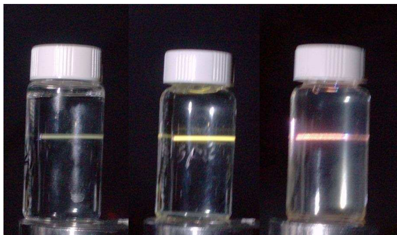
Figura 5.2: Amostras de pontos quânticos coloidais de CdS fluorescendo predominantemente nas cores verde, amarelo e vermelho. Neste caso as amostras estão sendo excitadas por um laser UV.
