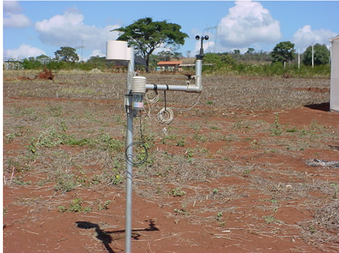
Figura 07: Estação meteorológica automática instalada próximo a área experimental, utilizada para o manejo da irrigação.
