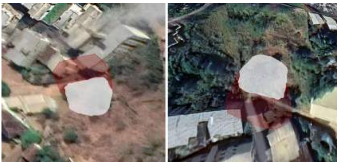
Figura 54 - Resultado da Análise de Alcance de Cid Gomes (vista de topo e perspectiva): superfície de ruptura em branco, alcance calculado da massa de solo rompida em vermelho. Fonte: Autor
