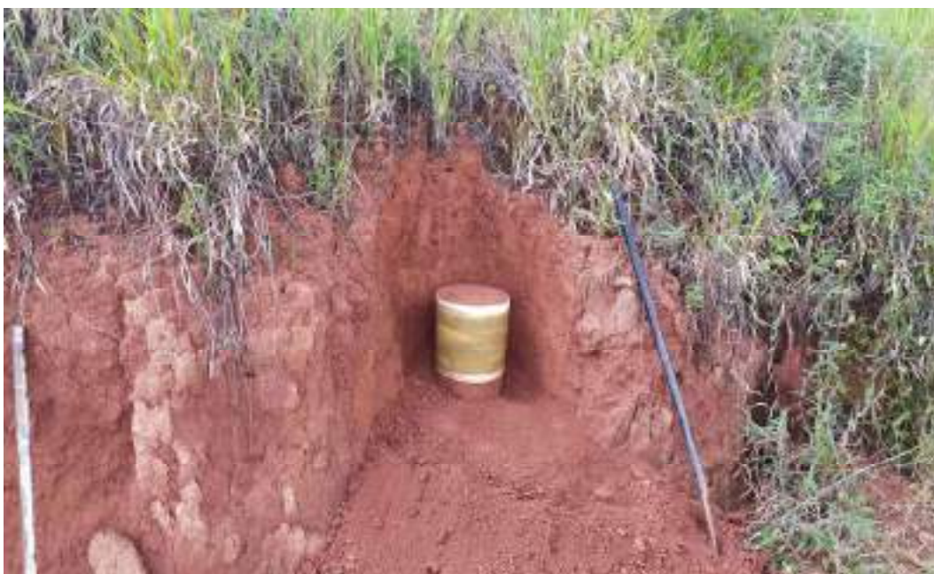
Figura 5 - Amostra Indeformada - SRM - Parque do Cristo. Fonte: Autor
