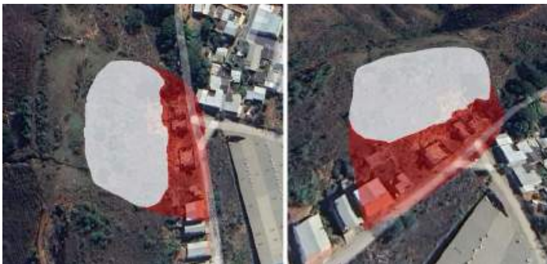
Figura 55 - Resultado da Análise de Alcance de João Afonso (vista de topo e perspectiva): superfície de ruptura em branco, alcance calculado da massa de solo rompida em vermelho. Fonte: Autor
