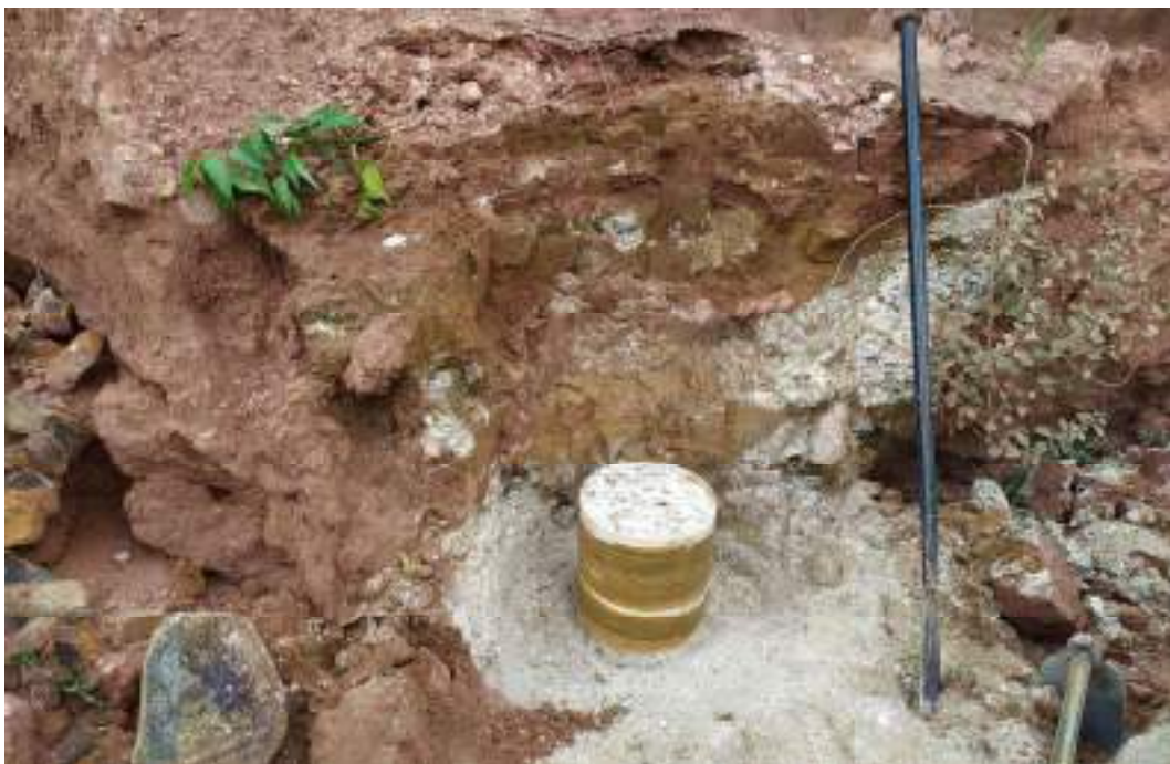
Figura 6 - Amostra Indeformada - SRJ - Parque do Cristo. Fonte: Autor
