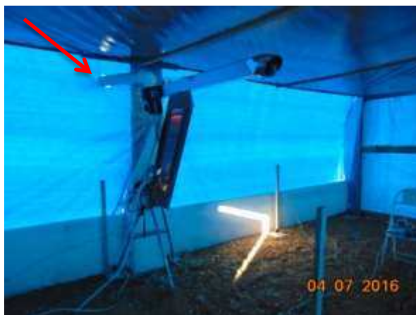
Figura 25 – Uso do ar externo para alimentação do sistema aquecimento.
