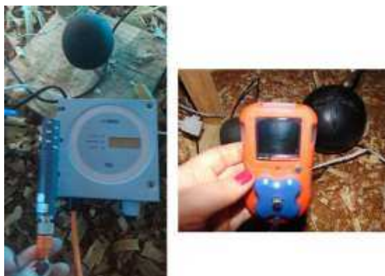
Figura 28 – Equipamentos utilizados para medição dos gases CO 2 e CO.
