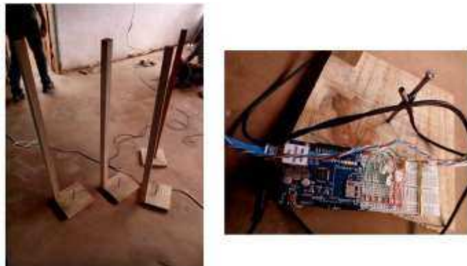
Figura 18 – Base de madeira para posicionamento dos sensores a diferentes alturas para medição da temperatura do ar aquecido.
