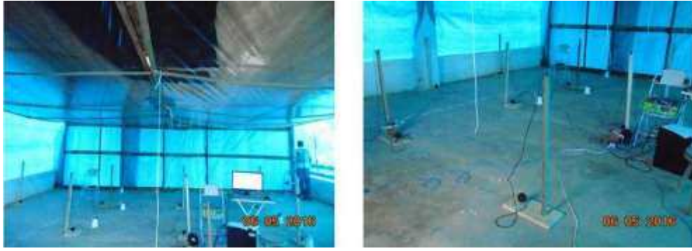
Figura 19 – Distribuição das bases para localização dos sensores ao longo módulo experimental.
