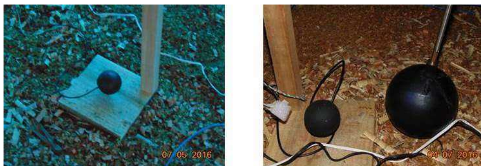
Figura 26 – Globo Negro alocado paralelamente no ambiente de coleta de dados para correção das temperaturas obtidas.
