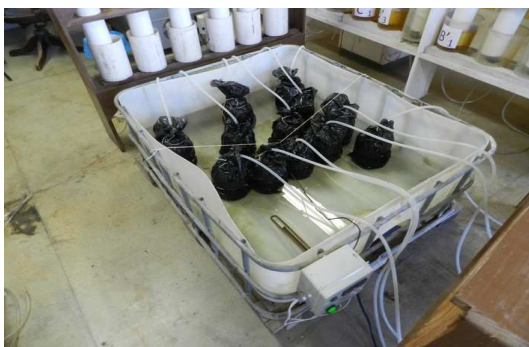
Figura 10: Câmaras biodigestoras envoltas em plástico e mergulhadas em água aquecida pelos componentes do sistema de controle de temperatura.
