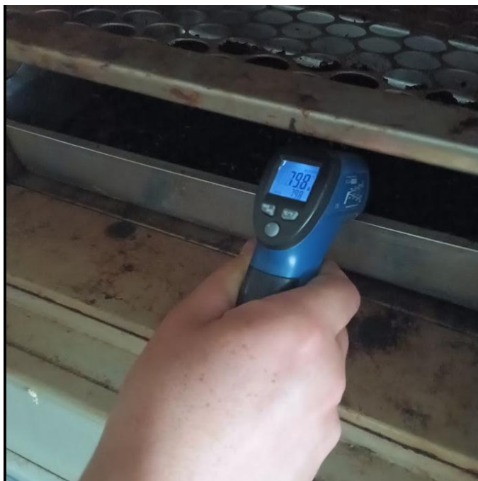
Figura 4 - Massa de subprodutos do abate de rã-touro ( Aquarana catesbeiana ) em secagem a 80 °C, monitorada via termômetro a Laser. Fonte: Elaboração própria.
