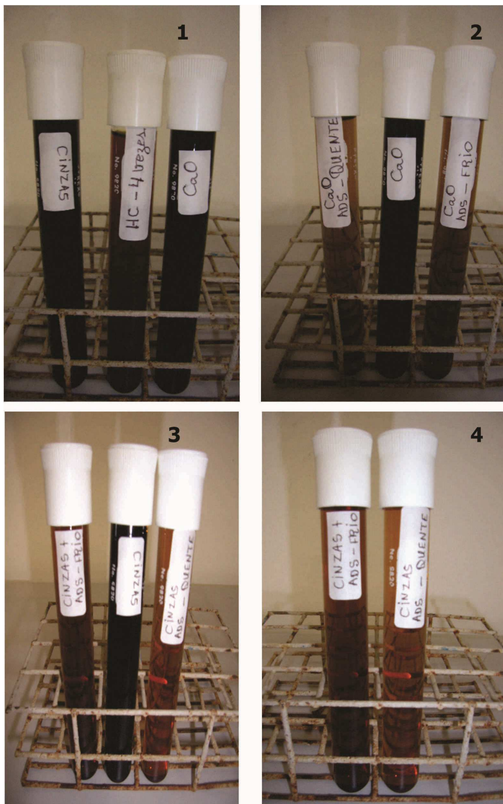
Figura 23 – Aspecto visual de amostras de hidrolisado hemicelulósico concentrado tratadas: 1. Neutralização ( \text{pH} = 6,4 ) com CaO ou cinza; 2, 3 e 4. Neutralização ( \text{pH} = 6,4 ) com CaO ou cinza antes e após adsorção com carvão ativado (5% m/v) a 30^\circ\text{C} (ADS – frio) ou a 60^\circ\text{C} (ADS – quente).
