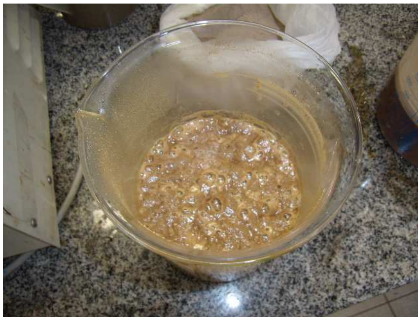
Figura 1B – Intensa formação de espuma no início da adição de cinza de eucalipto durante o tratamento por alcalinização do hidrolisado hemicelulósico de bagaço de abacaxi.
