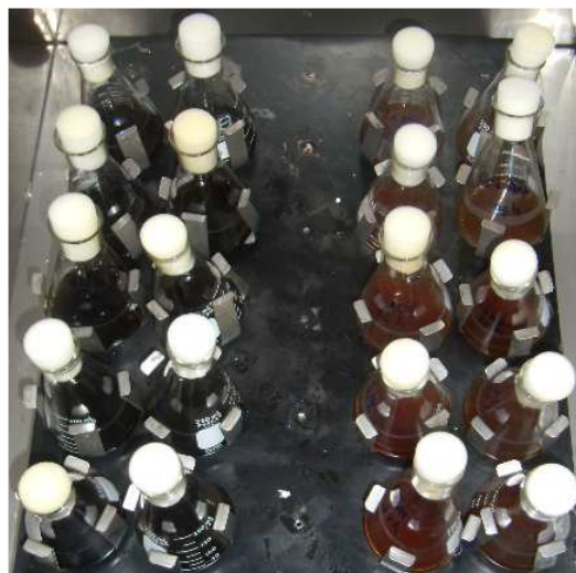
Figura 14 – Fermentação de HHBAC destoxificado, por D. hansenii UFV-170, em frascos Erlenmeyer incubados em shaker (30 °C, 200 rpm por 120 h).
