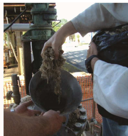
3. Adição de bagaço ao reator
