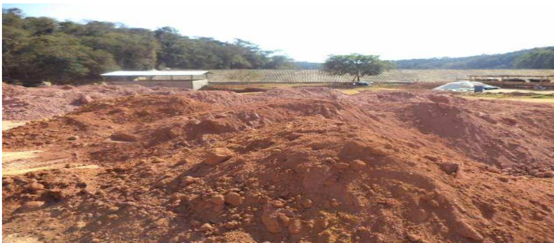
Figura 31. Disposição inadequada do material estéril da extração de cascalho em área da Jazida Gomide
