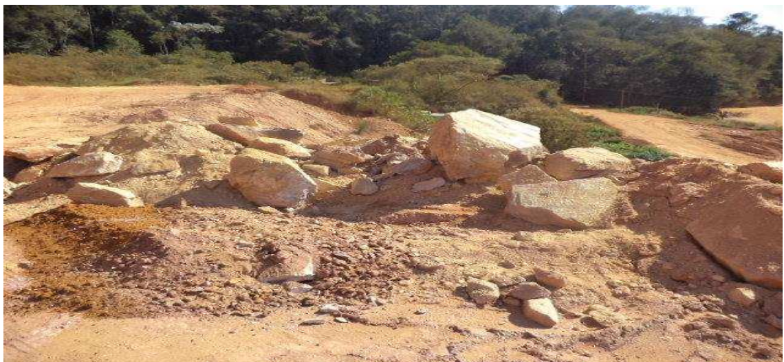
Figura 30. Disposição inadequada do material estéril da extração de cascalho em área da Jazida Gomide
