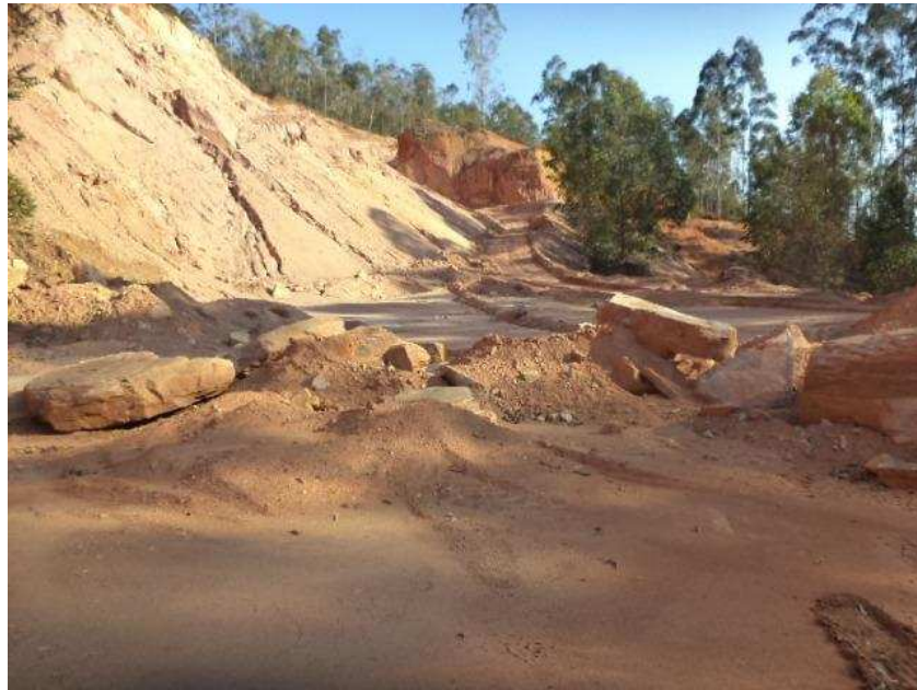
Figura 22. Disposição inadequada do material estéril da extração de cascalho em área da jazida Nô da Silva(a)
