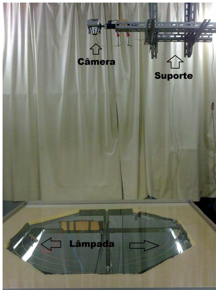
Figura 4.10: Foto da montagem da câmera e o suporte.
