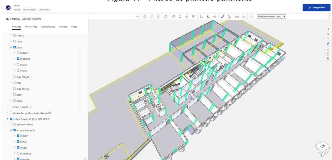
Figura 44 – Pilares do primeiro pavimento
