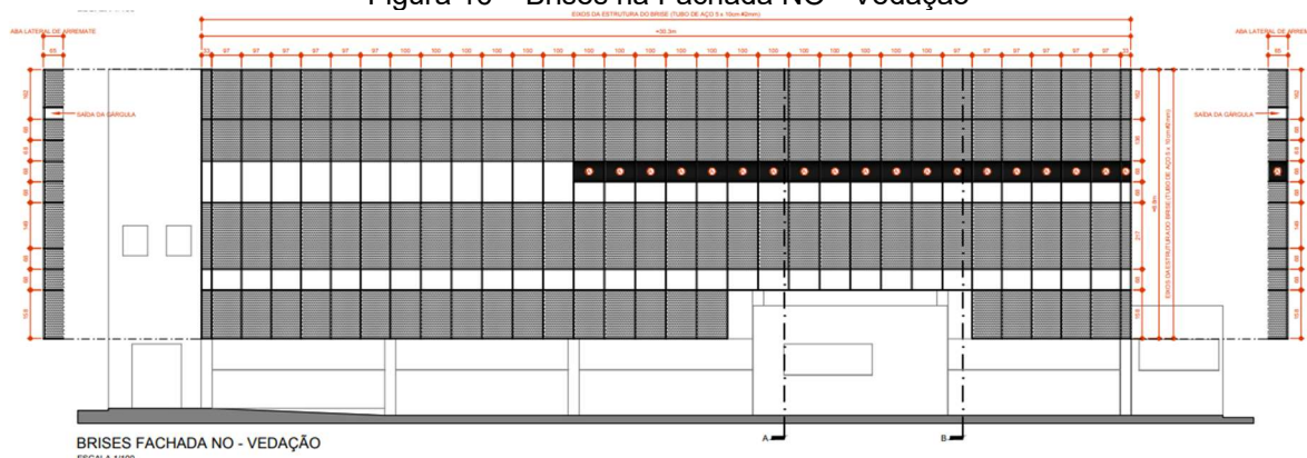
Figura 16 – Brises na Fachada NO - Vedação
