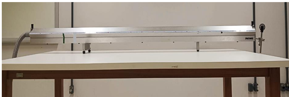
Figura 17 – Marcação sobre o trilho de ar indicando a posição em que o planador passa a ser puxado pelo porta-pesos
