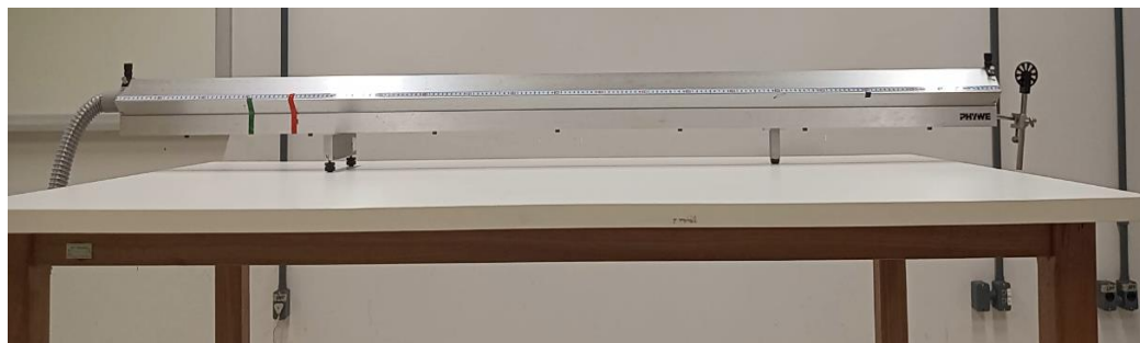
Figura 18 – Marcação no trilho de ar das posições inicial e final da tração do planador
