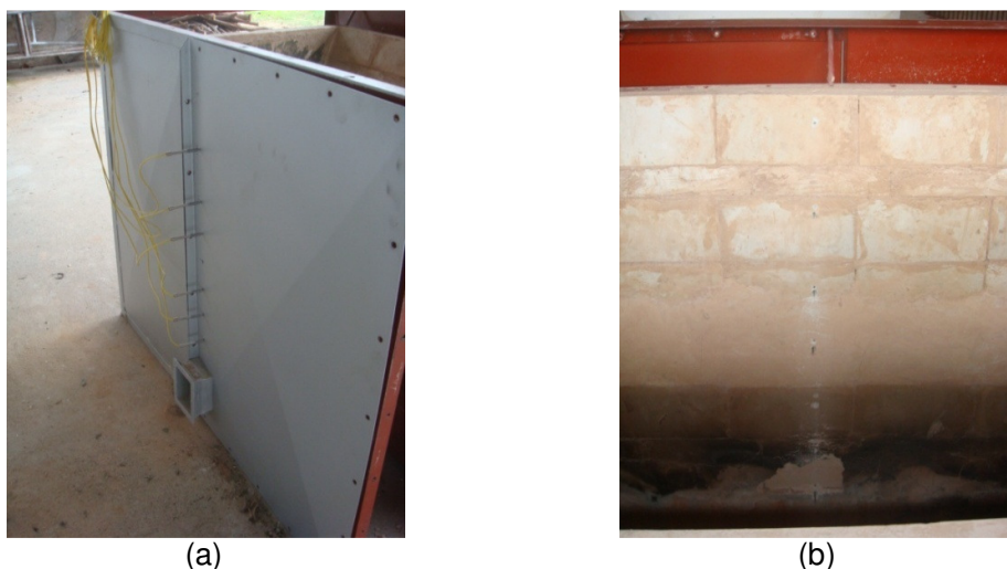
Figura 07. Instalação de termopares no gaseificador; a) visão da lateral externa; b) ponta dos termopares no lado interno do gaseificador.
