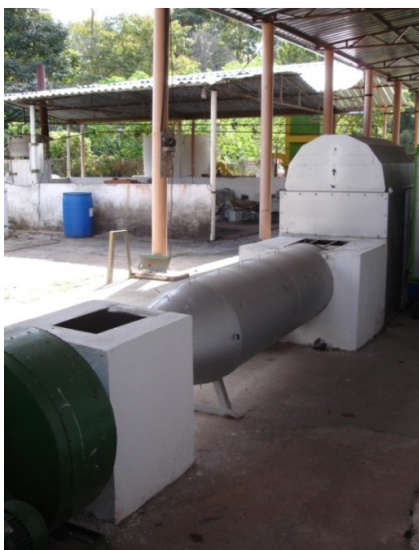
Figura 13. Detalhe das câmaras em alvenaria que ligam o reator à câmara de combustão e a câmara de combustão com o ventilador.
