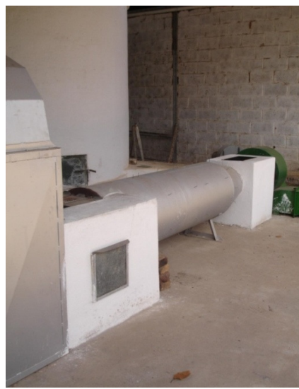
Figura 13. Detalhe das câmaras em alvenaria que ligam o reator à câmara de combustão e a câmara de combustão com o ventilador.
