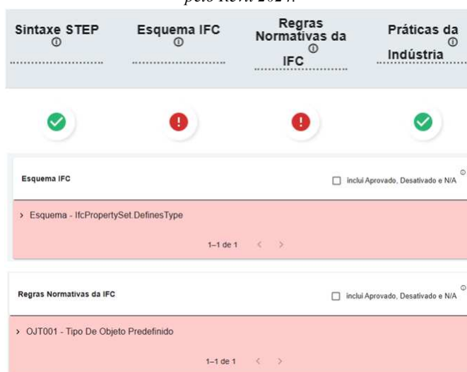
Figura 43: Resultado da validação pelo leitor da BuildingSMART para o arquivo .ifc gerado através do modelo produzido pelo Revit 2024.
