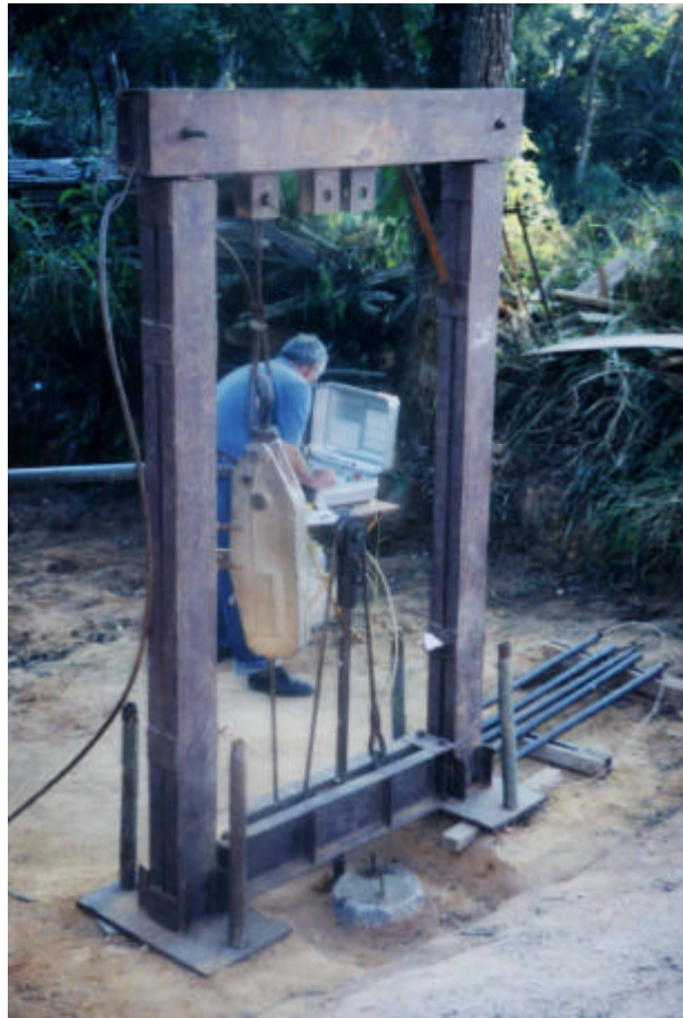
Figura 2.9 Sistema de reação do ensaio dilatométrico.
