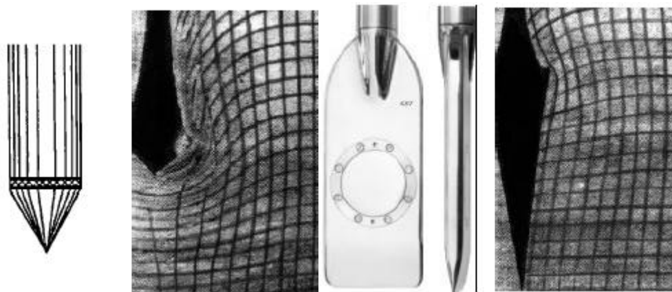
Figura 2.11 Comparação da camada deformada pela sonda do ensaio de cone e pela lâmina dilatométrica (Baligh & Scott, 1975).
