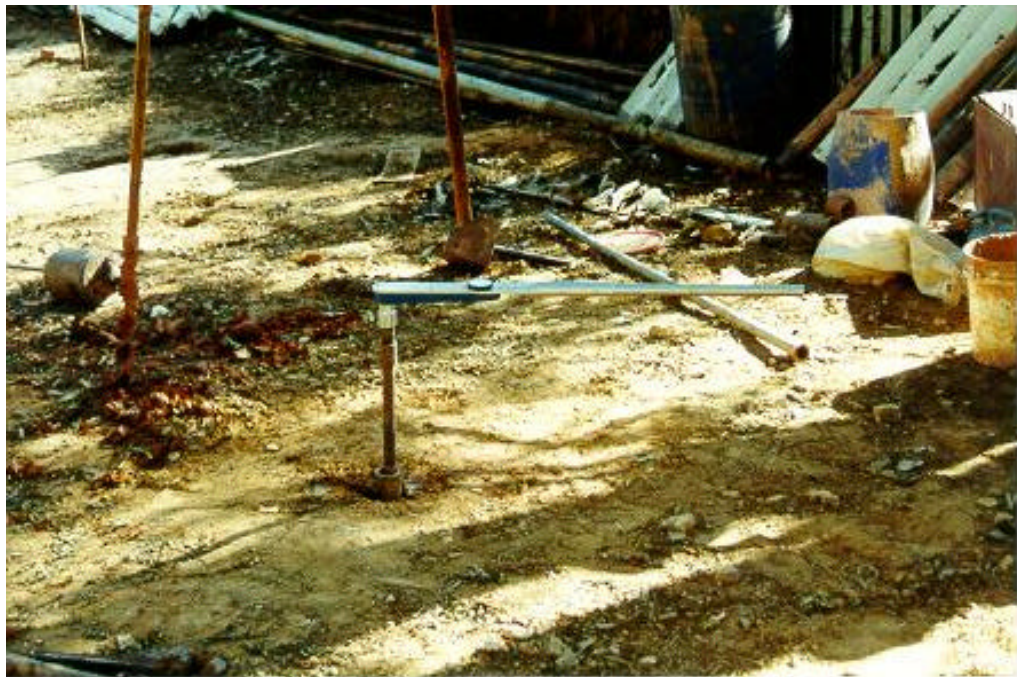
Figura 2.14 Torquímetro sendo utilizado no campo.
