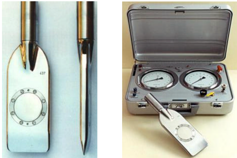
Figura 2.8 Ilustração da lâmina dilatométrica e da caixa de controle.
