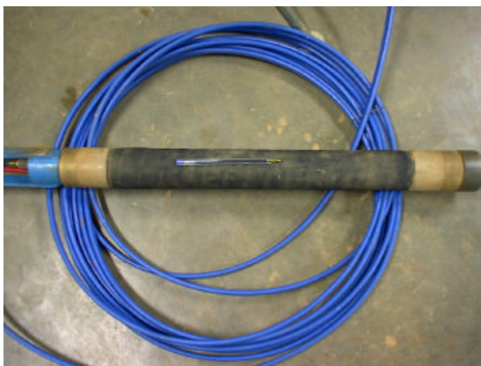
Figura 2.5 Sonda pressiométrica e mangueira de conexão.
