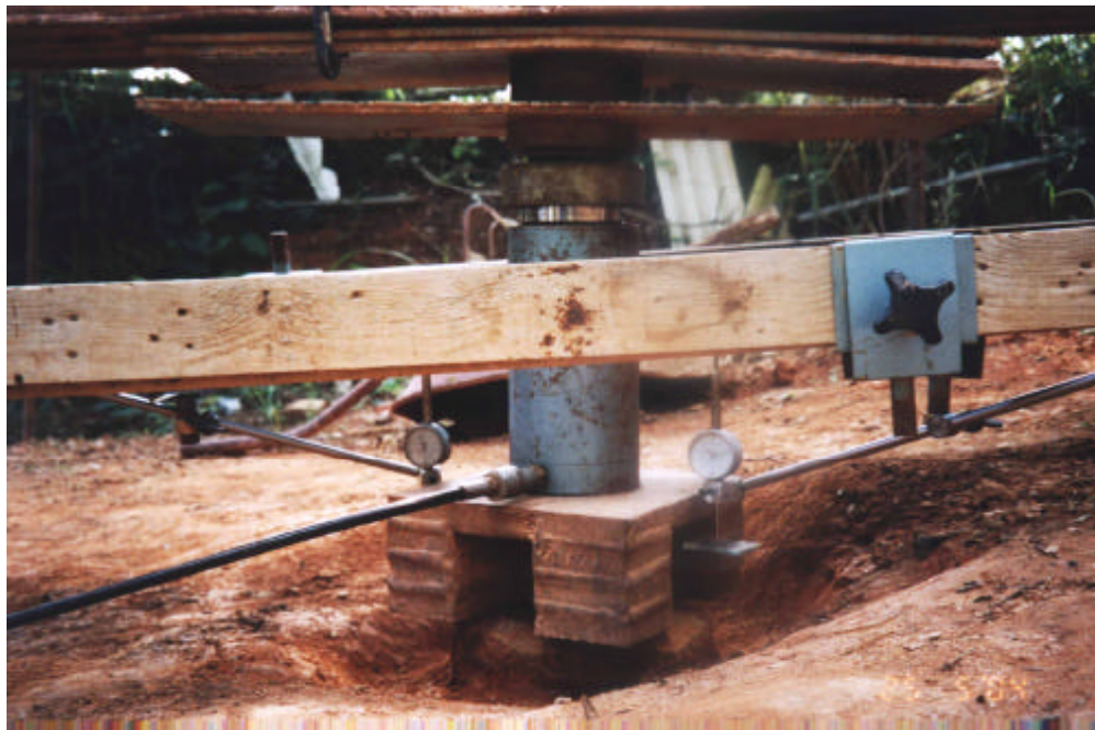
Figura 3.11 Instalação dos extensômetros e do macaco hidráulico de 500 kN.
