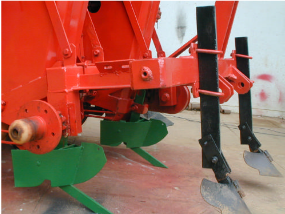
Figura 3 – Vista lateral do mecanismo adaptado à plantadora, mostrando sulcador frontal, e separador do adubo com haste escarificadora.
