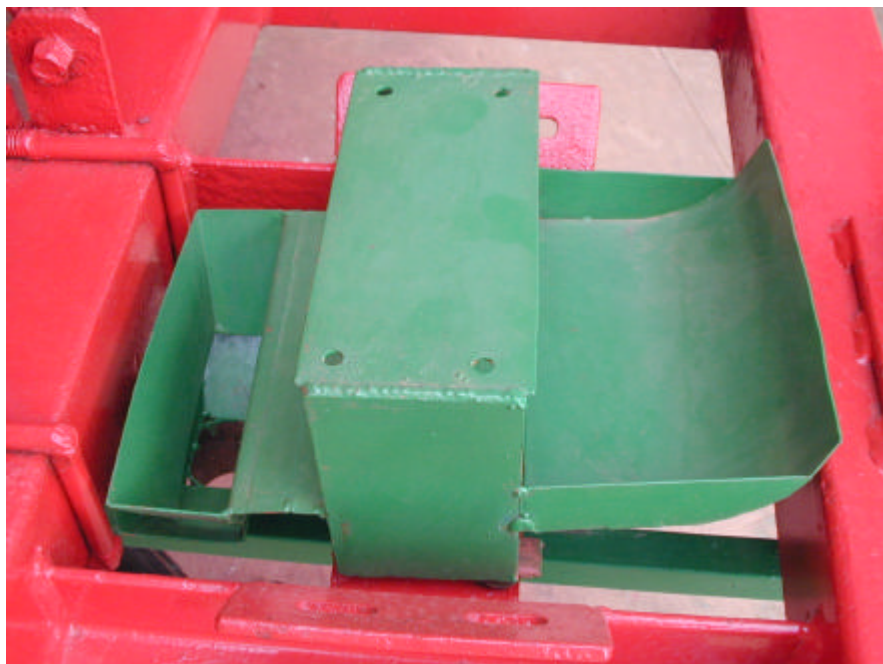
Figura 10D – Mecanismo coletor do adubo para condução até o sulcador.
