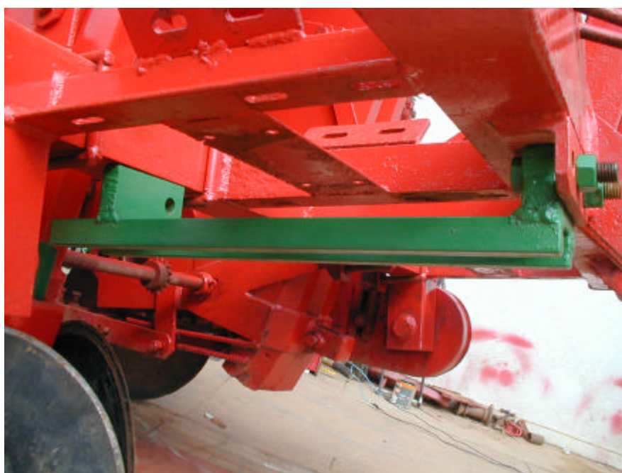
Figura 5D – Vista inferior da plantadora mostrando suporte do sulcador.
