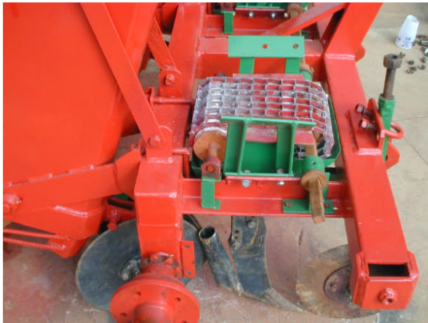
Figura 8D – Vista superior do mecanismo de distribuição de adubo, disco duplo, sulcador e disco cortador.
