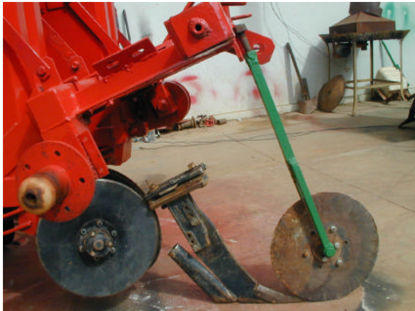
Figura 2D – Peças que foram adaptadas à plantadora para plantio em solo não-revolvido.
