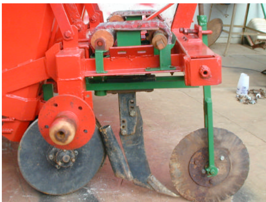
Figura 6D – Vista lateral da plantadora mostrando peças adaptadas para trabalho no solo e mecanismo de distribuição de adubo.
