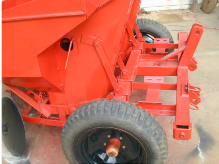
Figura 1D – Vista geral da plantadora mostrando detalhes da barra porta-ferramentas.
