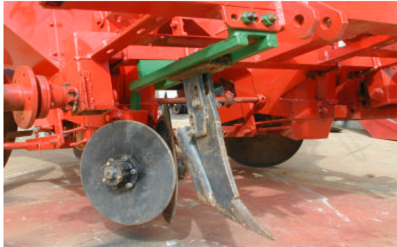
Figura 16 – Vista frontal da plantadora mostrando sulcador tipo bota – Adaptação 3.
