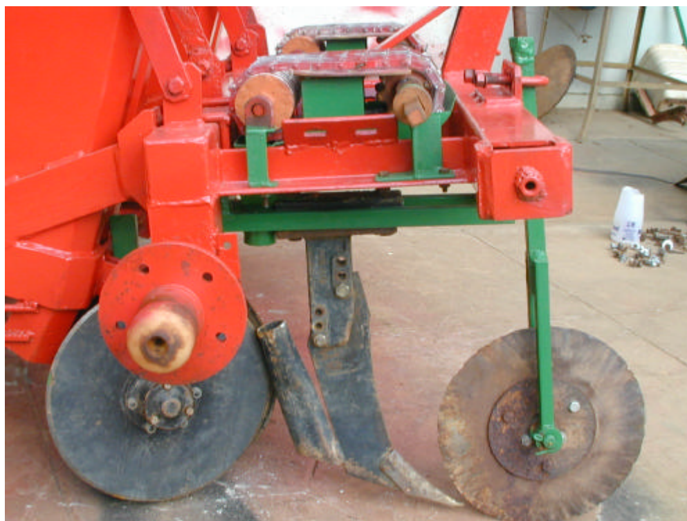
Figura 5 – Vista lateral do mecanismo adaptado à plantadora, mostrando disco de corte frontal, sulcador tipo bota, disco duplo, suporte do sulcador e elevação da esteira.
