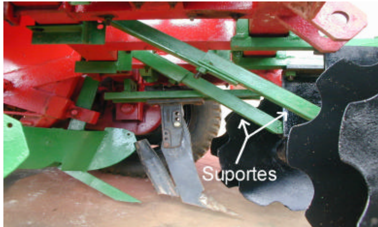
Figura 10 – Vista inferior da plantadora, com suportes de sustentação dos discos - Adaptação 2.
