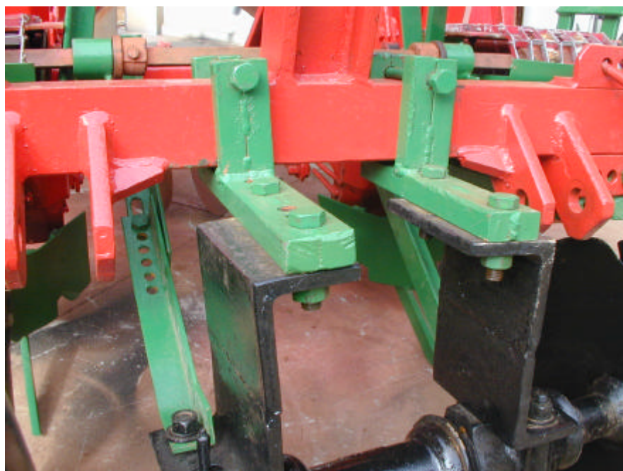
Figura 5E – Vista frontal da plantadora mostrando suportes de sustentação dos discos de grades
