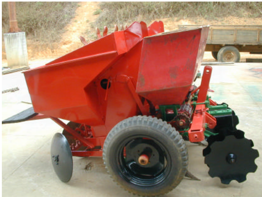
Figura 1E – Vista geral da plantadora adaptada com discos de grades e sulcador do tipo bota.
