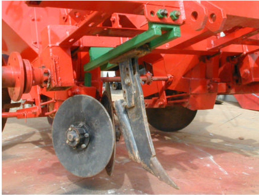
Figura 3D – Vista inferior da plantadora mostrando sulcador do tipo bota, suporte e discos duplos.
