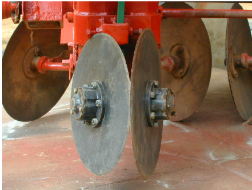
Figura 4D – Vista frontal dos discos duplos mostrando a defasagem entre os mesmos.
