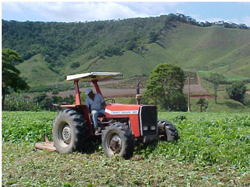
Figura 2A – Remoção da vegetação existente (mucuna preta) na área por meio de roçadora.
