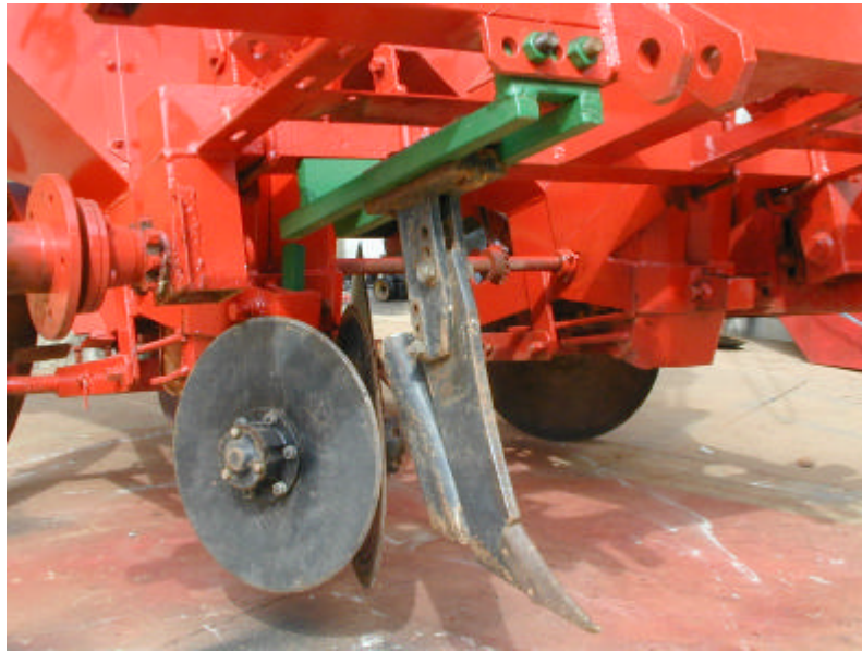
Figura 12 – Vista inferior da plantadora, mostrando peça fixadora do sulcador tipo bota – Adaptação 3.
