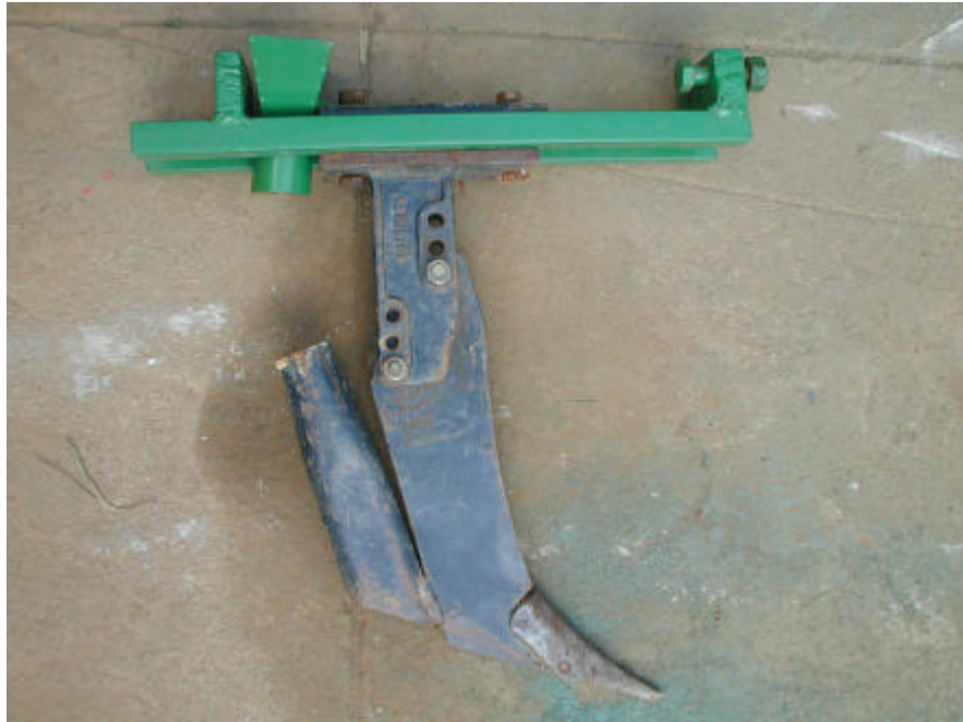
Figura 9D – Sulcador do tipo bota com suporte de sustentação.
