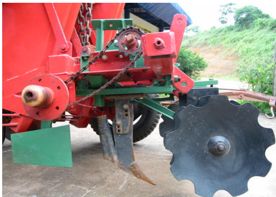
Figura 4 – Vista lateral do mecanismo adaptado à plantadora, mostrando conjunto de discos de grade, sulcador tipo bota e separador de adubo.
