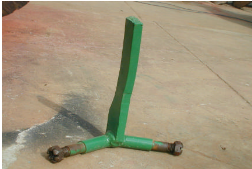
Figura 18 - Eixo e suporte para montagem do disco duplo – Adaptação 3.
