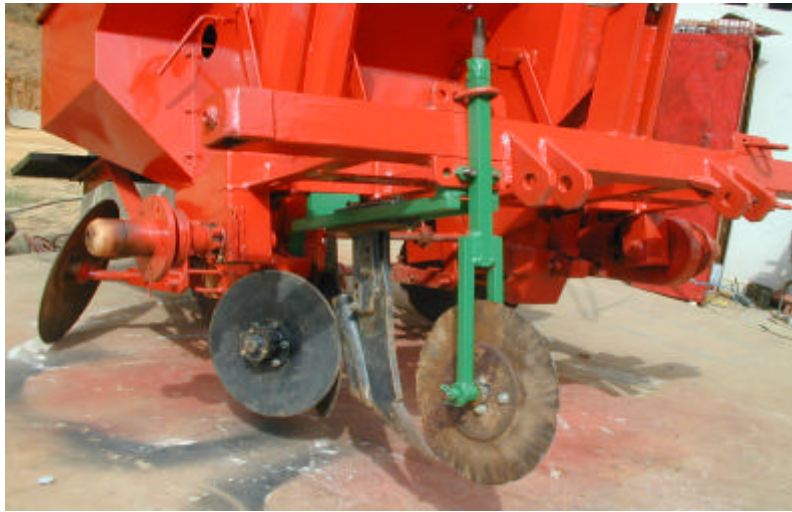
Figura 14 – Vista frontal da plantadora mostrando disco liso cortador e suporte utilizado na Adaptação 3.
