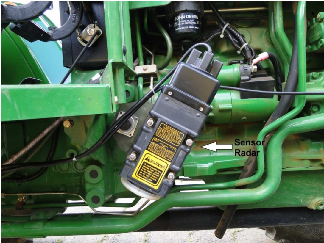
Figura 6 - Radar para medição da velocidade de deslocamento do trator.
