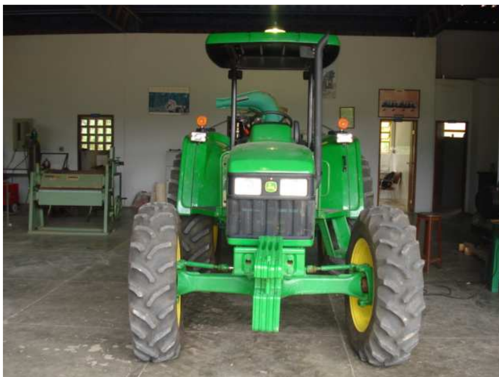
Figura 4 - Trator John Deere modelo 5705, equipado com pneus diagonais nos eixos dianteiros e traseiros.
