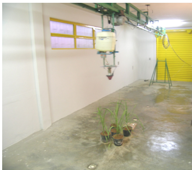
Figura 2 - Pulverizador centrífugo montado sob a barra de pulverização autodeslizante durante as aplicações de glyphosate.
