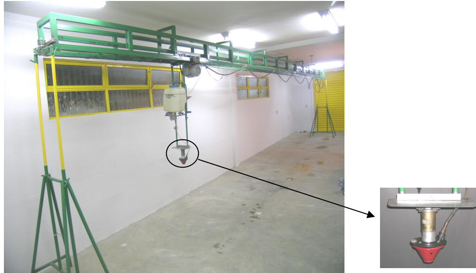
Figura 1 - Barra de pulverização autodeslizante equipada com o pulverizador centrífugo.
