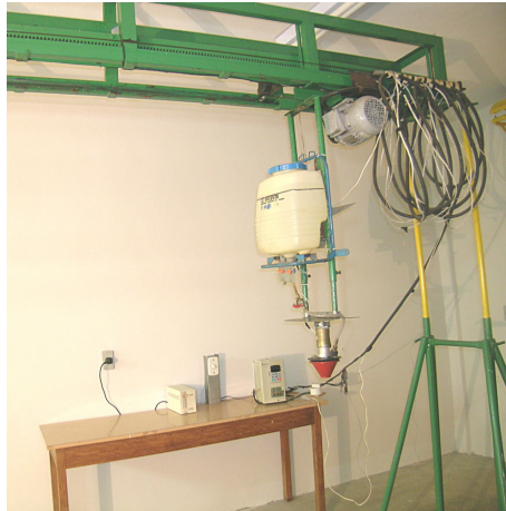
Figura 1 - Pulverizador centrífugo acoplado sob a barra de pulverização autodeslizante.
