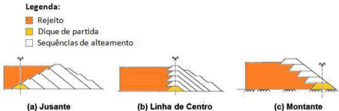
Figura 2. 10 - Métodos de alteamento de barragem
