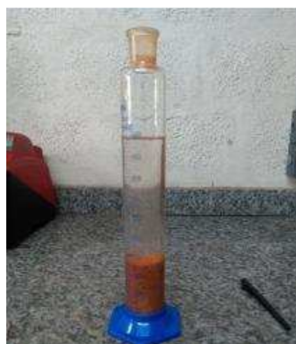
Figura 4. 3 - Rejeito de polpa após agitação na proveta (foto da esquerda), e a separação entre underflow e overflow ao fim da sedimentação (foto da direita)
