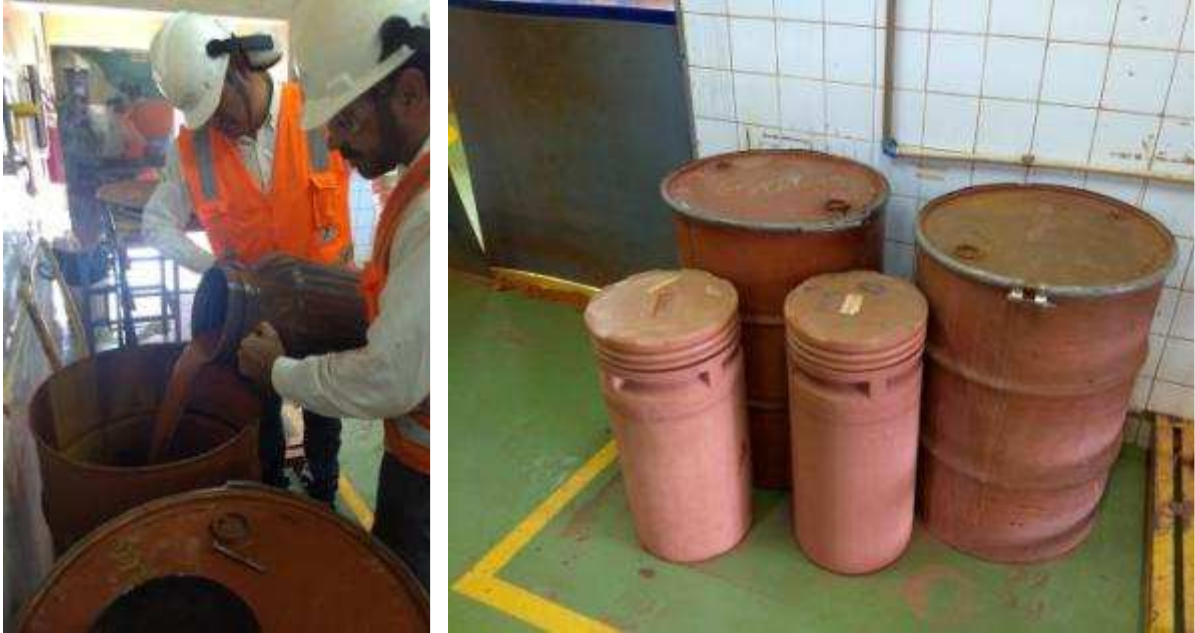
Figura 3. 3 - Armazenamento de 500 litros de rejeito para decantar os sólidos, retirar a água e preencher com mais polpa de rejeito
