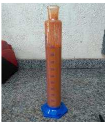
Figura 4. 3 - Rejeito de polpa após agitação na proveta (foto da esquerda), e a separação entre underflow e overflow ao fim da sedimentação (foto da direita)
