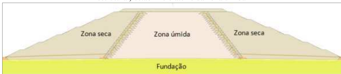
Figura 2. 14 - Distribuição espacial do aterro do depósito a seco, de modo que a zona seca (zona estrutural) estabilize o aterro da zona úmida
