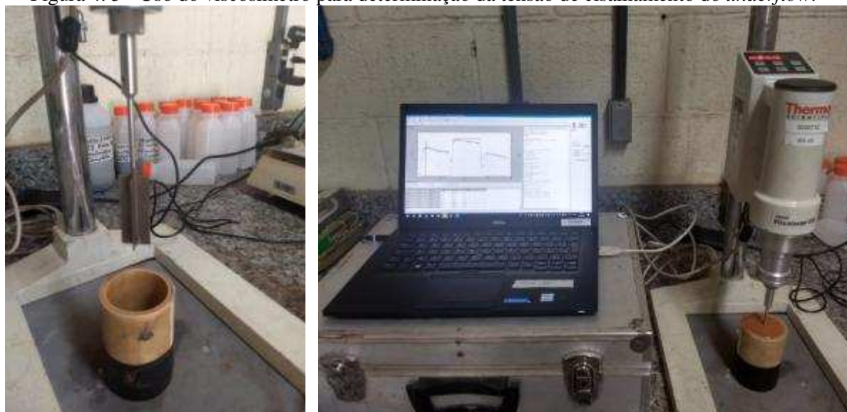
Figura 4. 5 - Uso do viscosímetro para determinação da tensão de cisalhamento do underflow .
