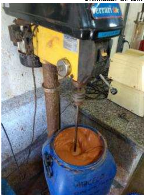
Figura 4. 1- Agitação mecânica da polpa para homogeneização (foto da esquerda), e medições estimadas do teor de sólidos (foto da direita)
