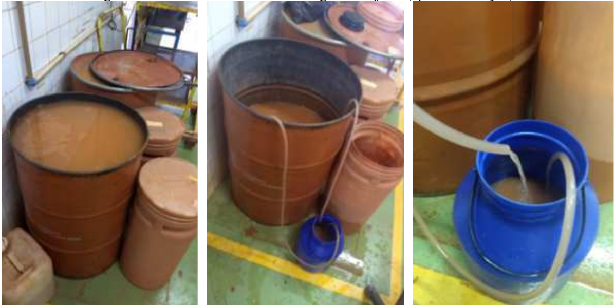
Figura 3. 4 - Processo de retirada de água do rejeito (após decantação)
