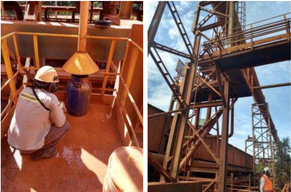
Figura 3. 2 - À esquerda o ponto de coleta do rejeito, e à direita a torre de sustentação da tubulação adutora que transporta a polpa de rejeito da planta de beneficiamento para os reservatórios de armazenamento
