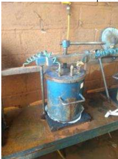
Figura 4. 2 - Equipamento para deságue da polpa por pressão (foto da esquerda), e a torta de rejeito após deságue (foto da direita)
