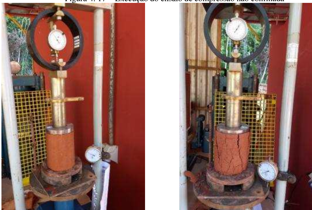
Figura 4. 17 - Execução do ensaio de compressão não confinada
